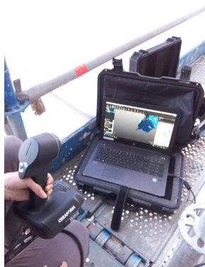
Fig. 48 - Numérisation d'un pinacle de la cathédrale au moyen d'un scan 3D portable (Creaform), 2018
