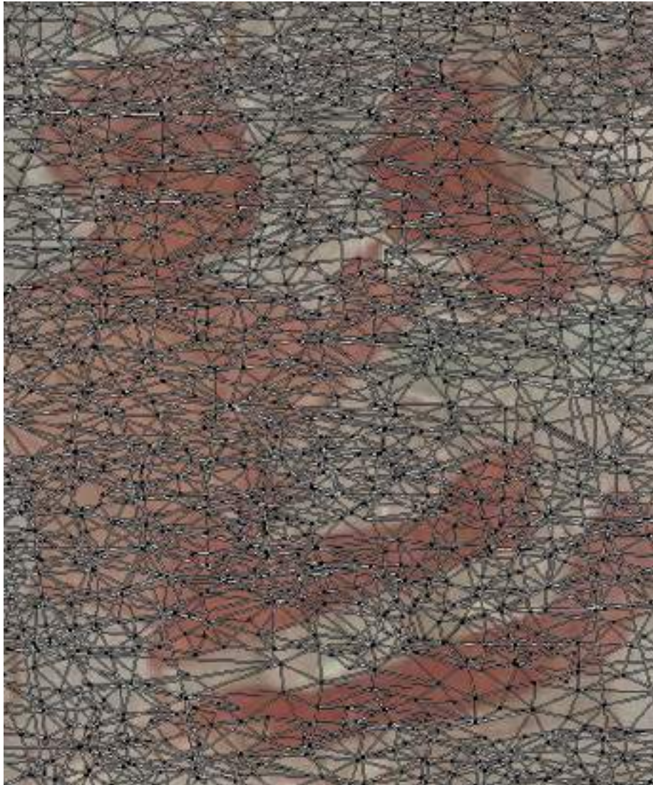
FIGURE 8.2 – Exemple de "mapping" de texture, ici zoom un détail de la paroi gauche de la salle longitudinale(Large Hall Left).
