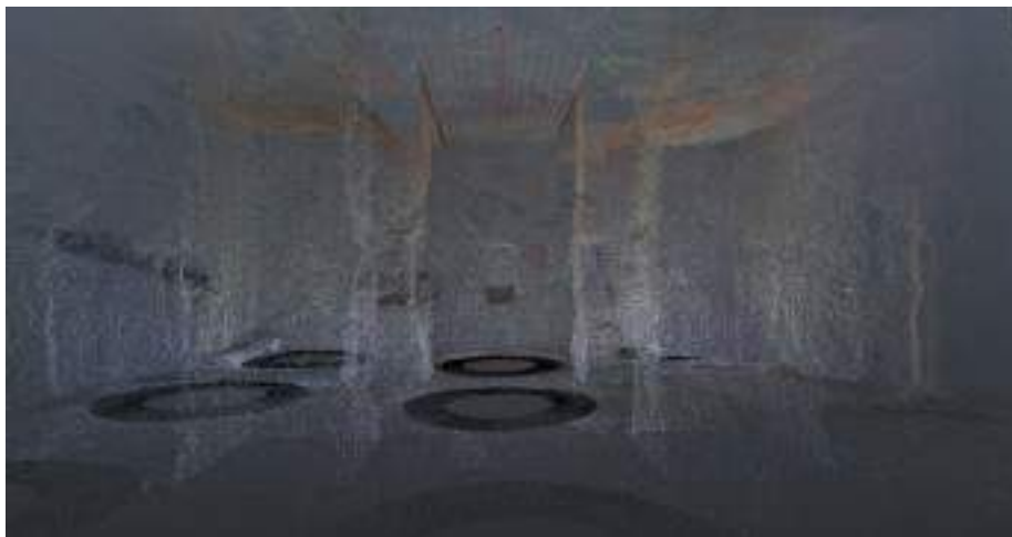
FIGURE 5.7 – Salle des piliers oservée dans ReCap, les différents cercles noirs sont les zones d'ombre non scannées par l'appareil étant donné qu'il s'agit de ses différents emplacements.
