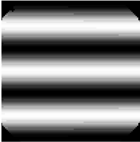
FIGURE 3.6 – Image du miroir avec les franges données par le détecteur de la caméra. Des figures en escalier sont présentes un peu partout. C'est le phénomène de crénelage.
