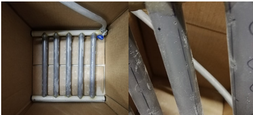
FIGURE 3.2 – L'injecteur d'air est le collage de tuyaux illustré. Uniquement les tuyaux gris sont percés. Les trous sont disposés de telle sorte que l'air est injecté vers le bas. Cela pour éviter qu'ils ne se remplissent de sable.
