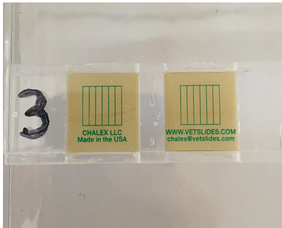
Figure 4 : Lame de MacMaster comportant 2 chambres remplies de liquide de dilution des matières fécales.
