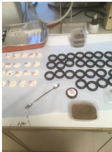
Figure 12: Mise en cellules des échantillons
