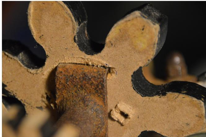
FIGURE 34 – Signes d'usure sur l'engrenage 2
