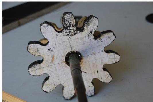
FIGURE 26 – Engrenage en MDF sur roulement à billes
