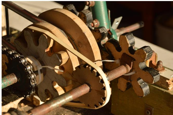
FIGURE 33 – Courroie de restitution entre l'axe 2 et l'axe 1
