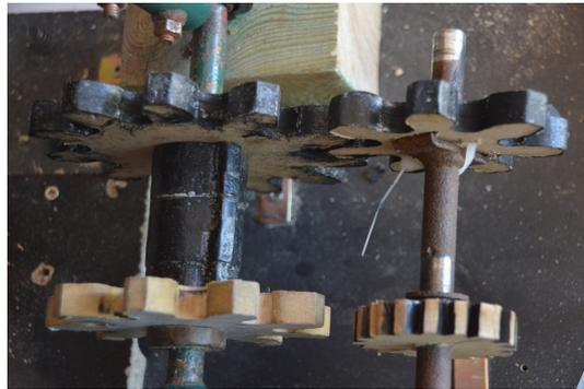
FIGURE 28 – Glissière servant de support à l'embrayage et mécanisme de transmission par engrenage entre l'axe 1 et 2
