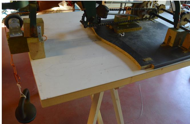
FIGURE 35 – Dispositif "masse-poulie" de prise de mesures
