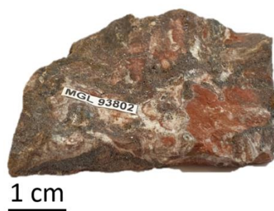
Figure 25 : Echantillon de magnétite, hématite et quartz (AMO 05).
