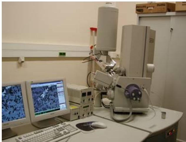
Figure 40. Philips XL30 ESEM FEG. Courtesy of https://www.mtm.kuleuven.be/equipment/ESEM-XL30-FEG/ESEM-XL30-FEG
