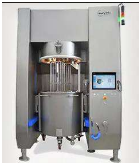
Figure 53: Mélangeurs planétaires ULTIMIX
