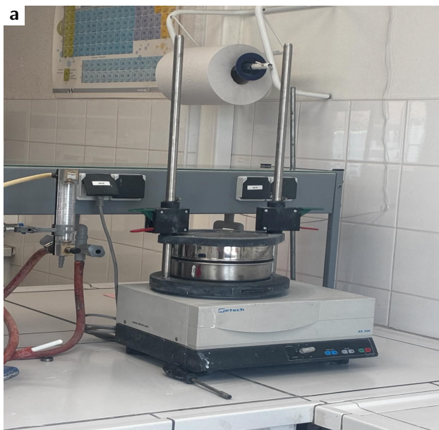
Figure 10 – Étapes de prétraitement et de lixiviation acide : (a) tamisage vibrant de la BM à 75 \mu\text{m} ; (b) lixiviation acide sous agitation mécanique.
