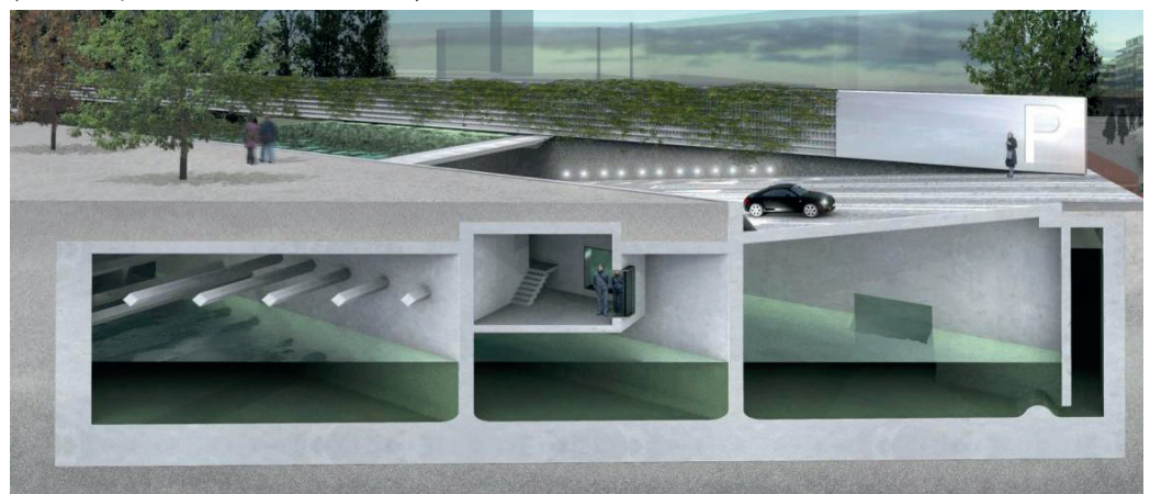
Figure 3.25. Museumpark garage : stationner et collecter l'eau
