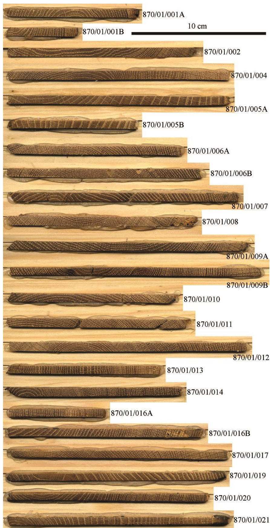
Figure 79 : Maison Libotte, Échantillons préparés avant analyse. Les aubiers sont à droite sur le cliché (©ULiège-CEA).
