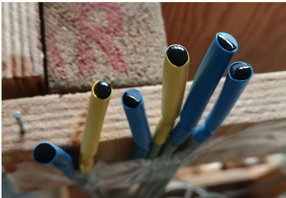
Figure 36 Imperméabilisation à la résine bi-composant des sondes LM35, (Source : Florent Lowet).
