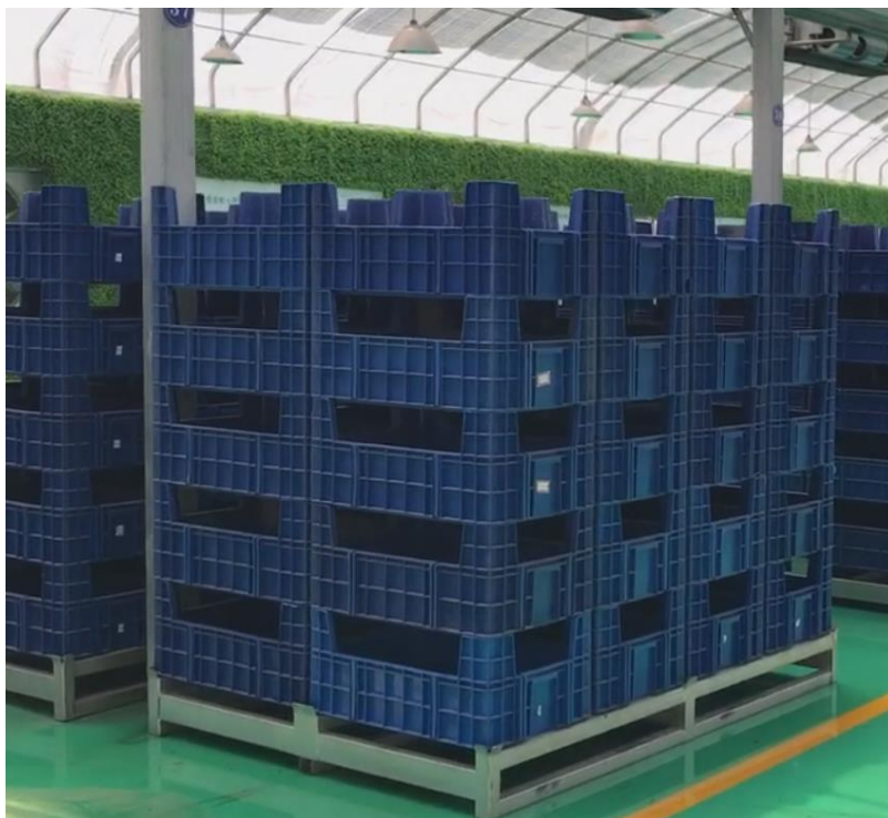
Figure 10 Bacs de grossissement des larves d' H. illucens utilisées pour le traitement des déchets de Beijing (Chine), une palette porte 40 bacs de grossissement et permet le traitement de 500kg de déchets en 10 jours (Source : https://www.evoconsys.com/blog/what-we-do-in-china-teamwork-through-evo-jmgreen# ).
