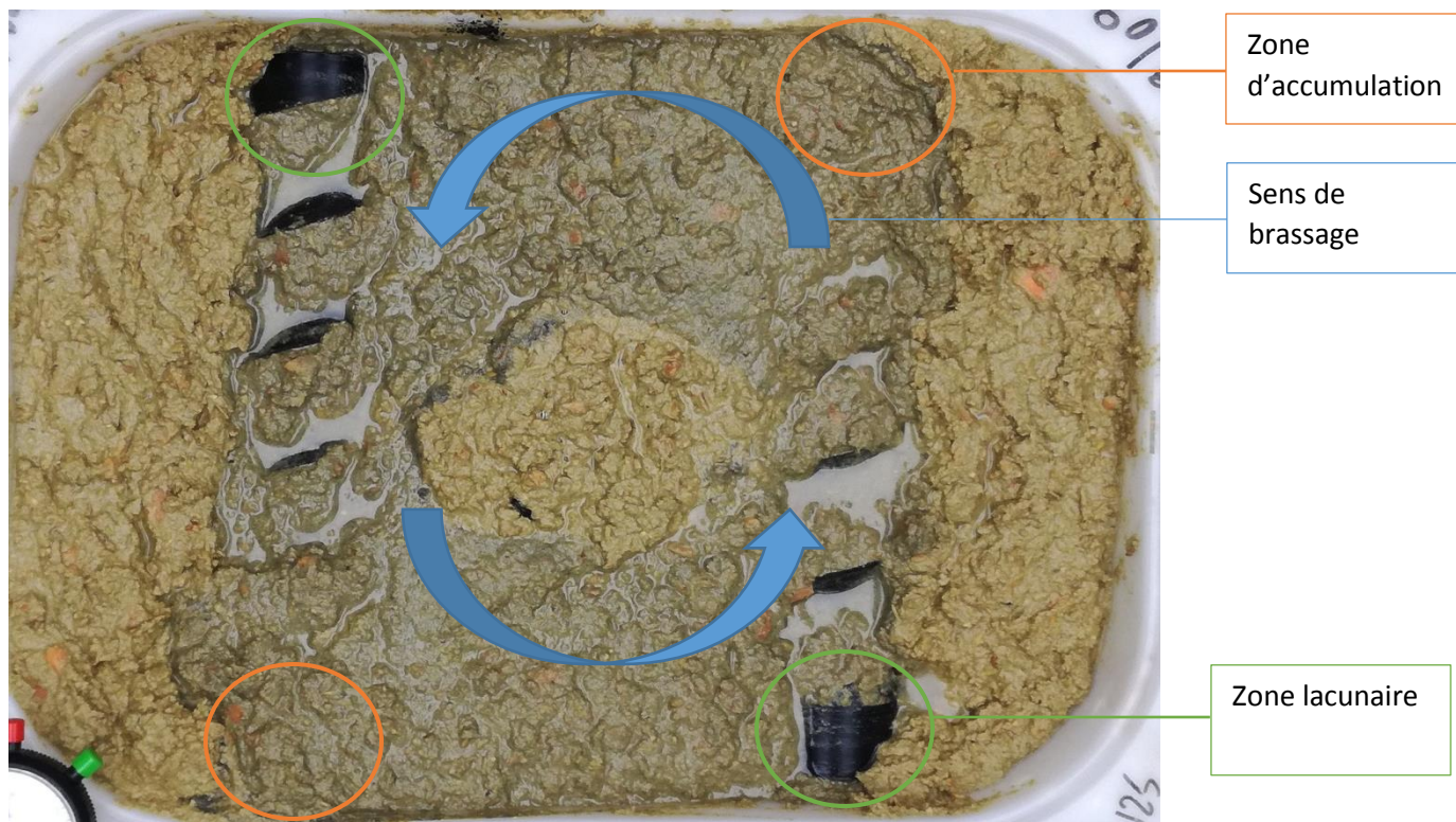
Figure 20 Fonctionnement du système de brassage après 20 minutes de brassage avec un espacement de 18 cm des vis, les zones brassées sont grisées par le colorant tandis que les zones non brassées restent jaune, (Source : Florent Lowet).
