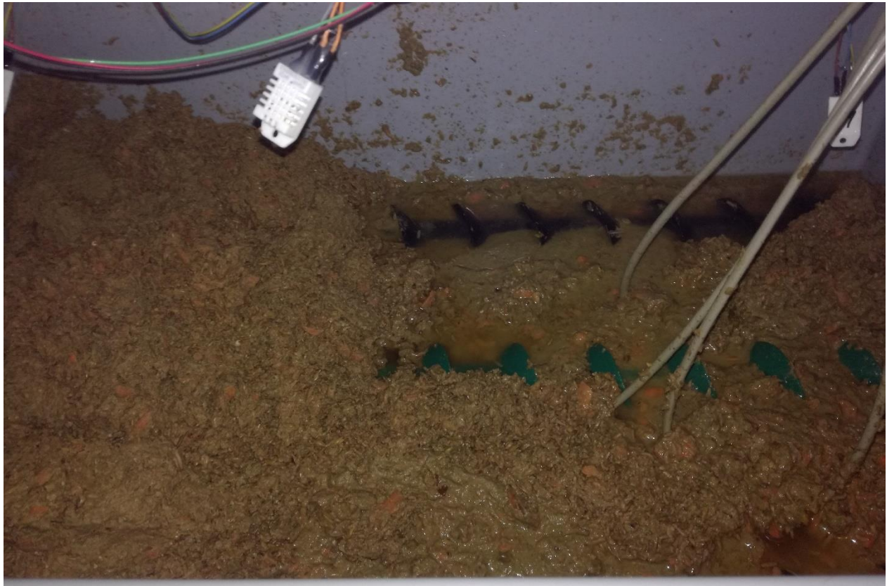
Figure 42 Hétérogénéité de la répartition du substrat du bac 1_1 suite à la rupture de la vis centrale (vis verte). Le substrat s'accumule sur la partie gauche du bac créant des zones de stagnation d'eau sur la partie droite du bac, (Source : Florent Lowet).
