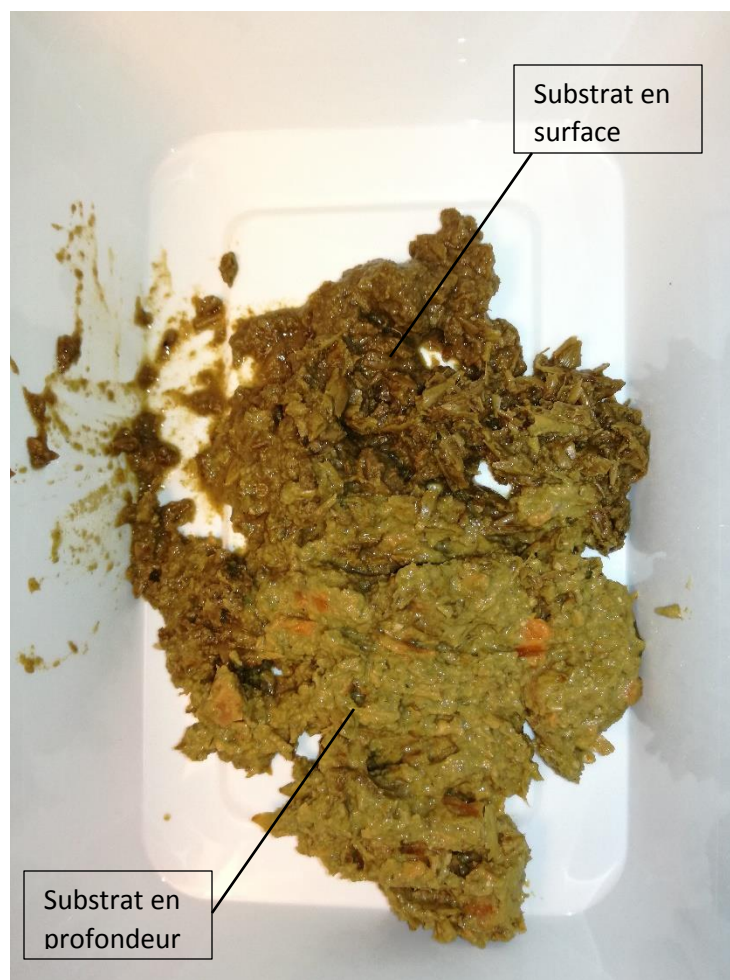
Figure 48 Différence de transformation du substrat d'une carotte réalisée à la cuillère sur toute la hauteur du substrat, substrat foncé en surface et substrat intact en profondeur, (Source : Florent Lowet).
