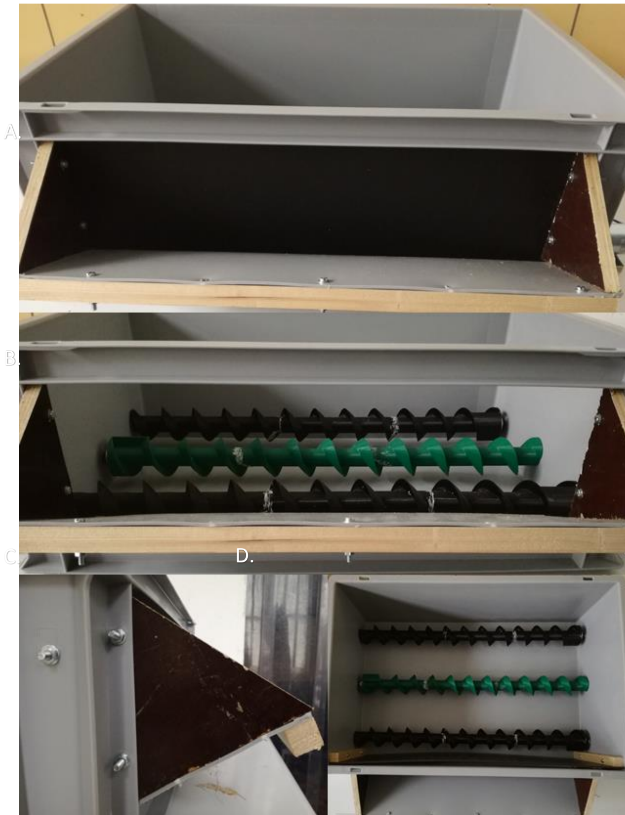
Figure 17 Prototype du bac d'élevage : A. Photo avec accès à la rampe fermée ; B. Photo avec accès à la rampe ouverte ; C. Pente de 30° du système de récolte ; D. Vue du dessus du bac, (Source : Florent Lowet).
