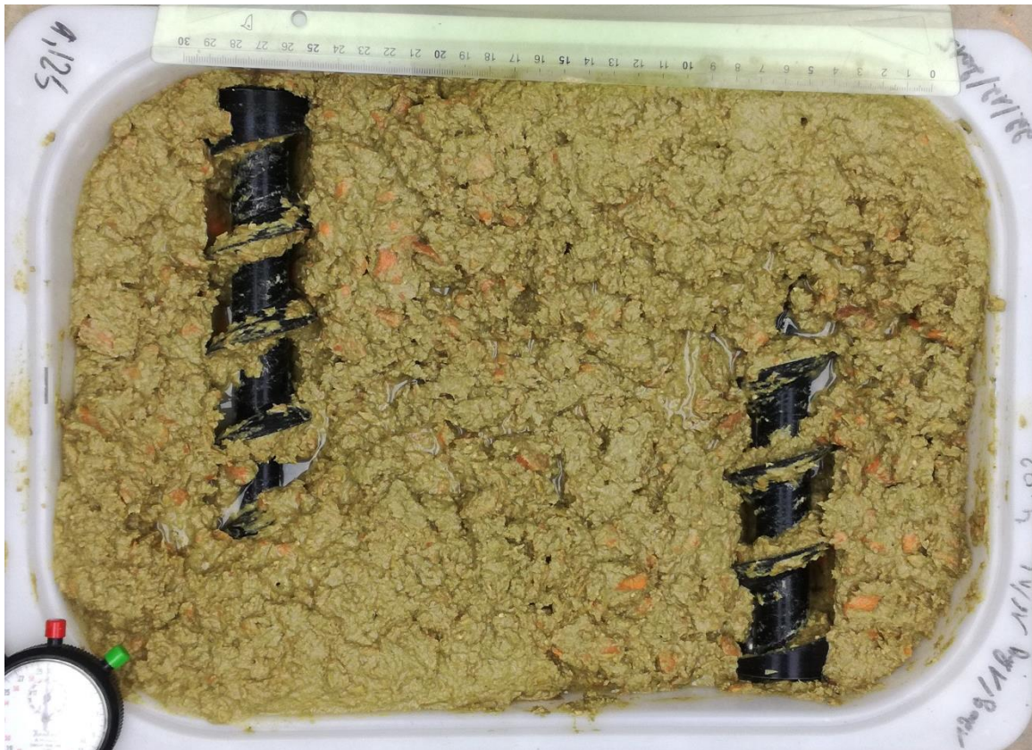
Figure 18 Test de brassage avec un espacement des vis de 23 cm, (Source : Florent Lowet).
