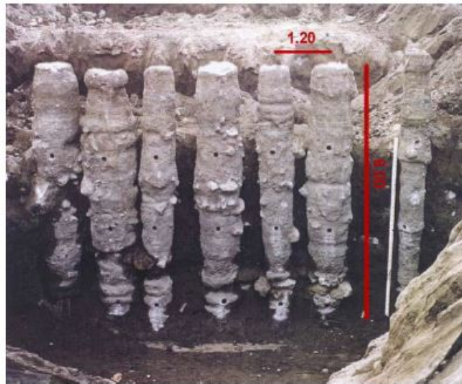
FIGURE 23 – Variation de diamètre typique pour des colonnes en jet grouting [Denies, Huybrechts, 2013]
