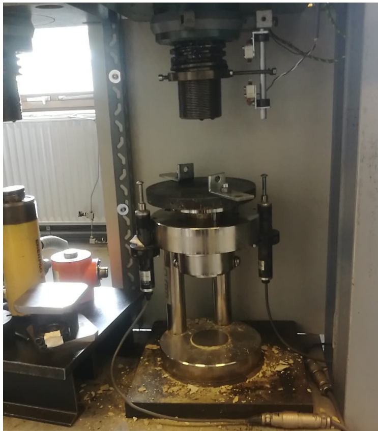
FIGURE 49 – Machine de compression simple pour matériaux rocheux
