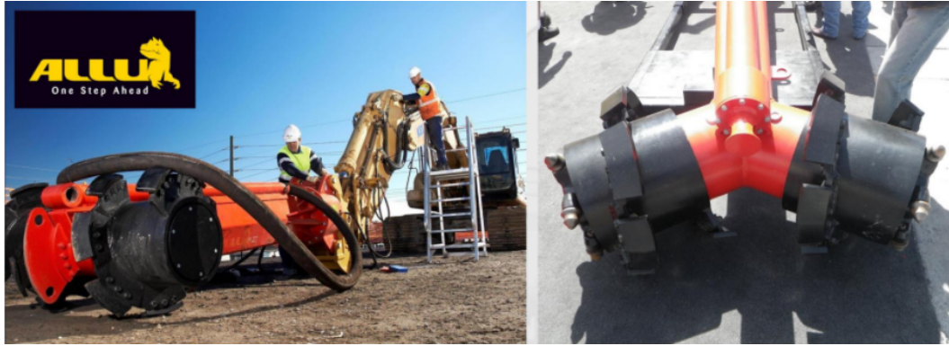
FIGURE 39 – Outil de stabilisation de masse [Denies, Huybrechts, 2013]
