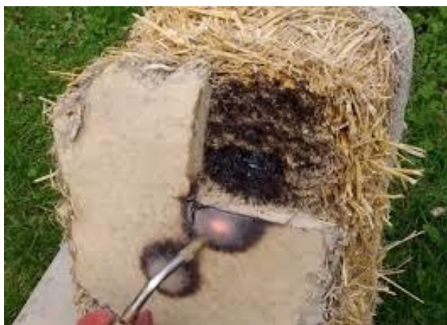
Figure 15 – Résistance au feu d'un ballot enduit
