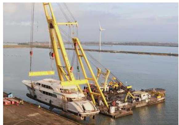
Figure 10 - Bigue utilisée pour lever un bateau (HEBO lift 6 et 7)
