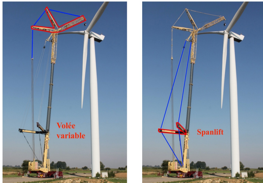
Figure 12 - Grue mobile sur porteur équipée d'une volée variable et d'un spanlift
