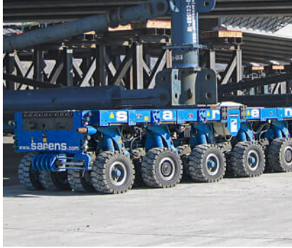
Figure 110 - SPMT Kamag K24 de chez Sarens
