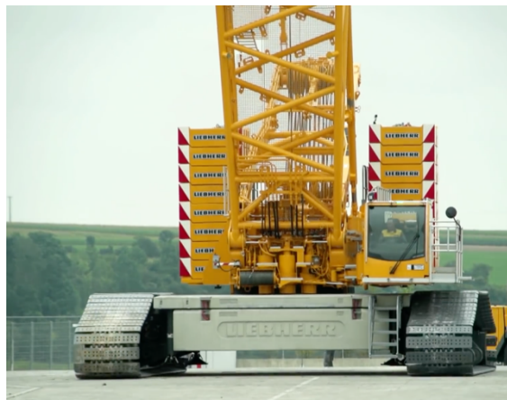
Figure 8 - Grue mobile sur chenilles (LR 500)
