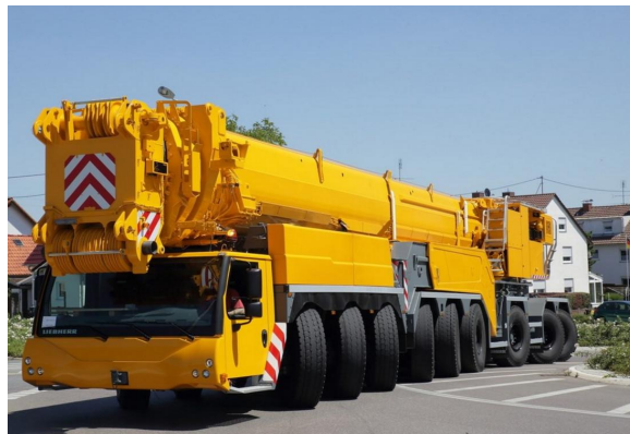
Figure 5 - Grue mobile sur porteur (LTM 1750-9.1)
