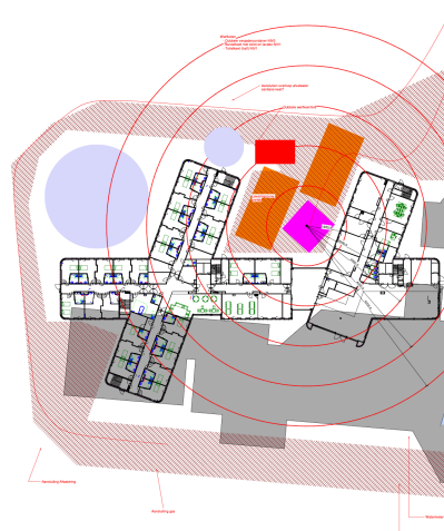
Figure 8 - Plan de montage de la société Ibens - Phase 2 du projet
