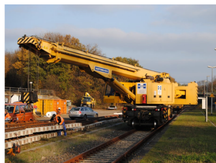
Figure 70 - Grue sur rail - KRC 810 125t
