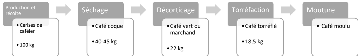
Figure 6 : Opérations, produits et masse 5 dans la transformation par voie sèche de café Robusta
