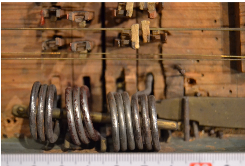
Figure 89: Vue du dessus des ressorts du côté droit de l'instrument.
