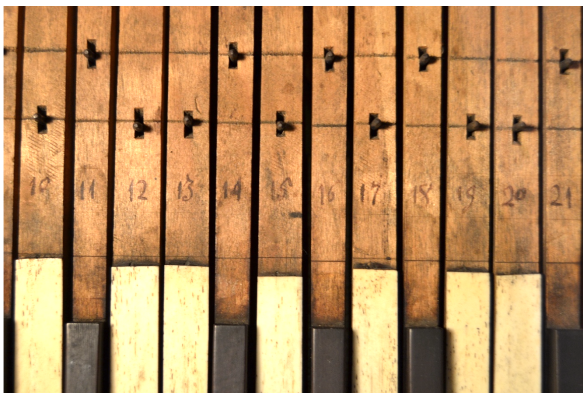
Figure 122: Numérotation du clavier supérieur.
