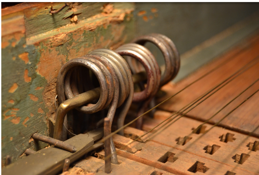
Figure 88: Les ressorts permettent de garder les registres dans leur position initiale. Les ressorts sont un des éléments importants des instruments de J.P. Bull.
