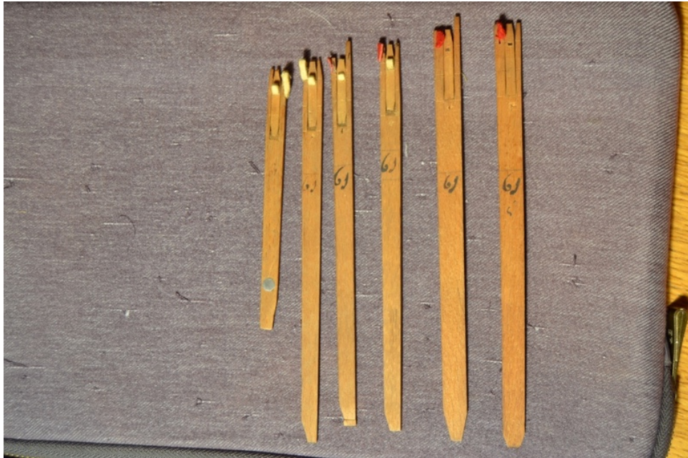
Figure 128: Les deux sautereaux à l'extrémité droite sont deux des sautereaux de l'instrument de 1776. On voit clairement la différence de largeur importante des sautereaux.
