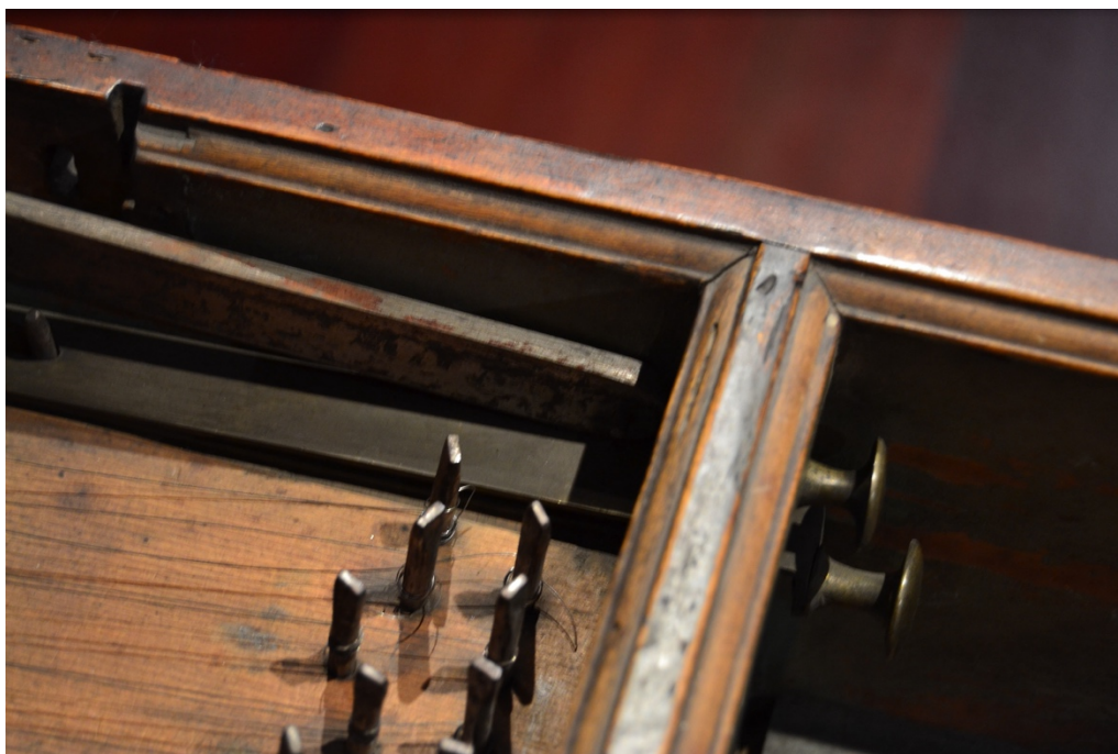
Figure 84: Les mêmes tirettes que la figure précédente. Les tirettes passent à travers une petite mortaise dans la gorge et sont fixées sur le sommier.
