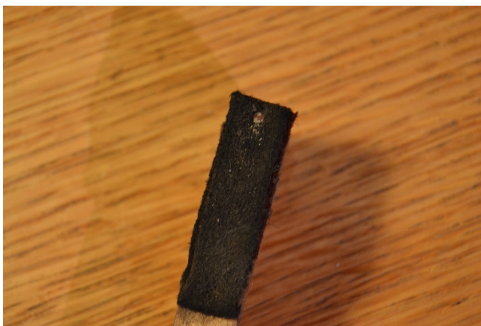
Figure 118: Touche du clavier supérieur. Détail du feutre noir.
