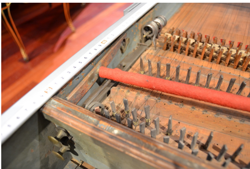
Figure 59: On voit ici la gauche du mécanisme du jeu de luth. On voit le ressort dans le coin inférieur gauche qui désengage le mécanisme quand il n'est pas actionné. On peut également voir la partie qui arrête la descente du mécanisme.
