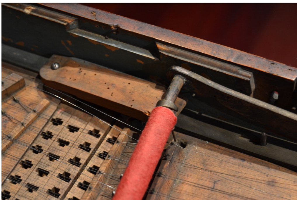
Figure 85: Les extrémités postérieures des tirettes sont en contact avec les registres.
