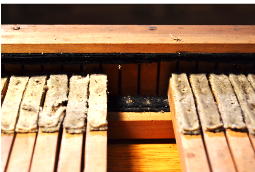
Figure 112: Rainures dans le peigne du clavier inférieur. C'est une pointe plantée dans l'extrémité de la touche qui coulisse dans la rainure.
