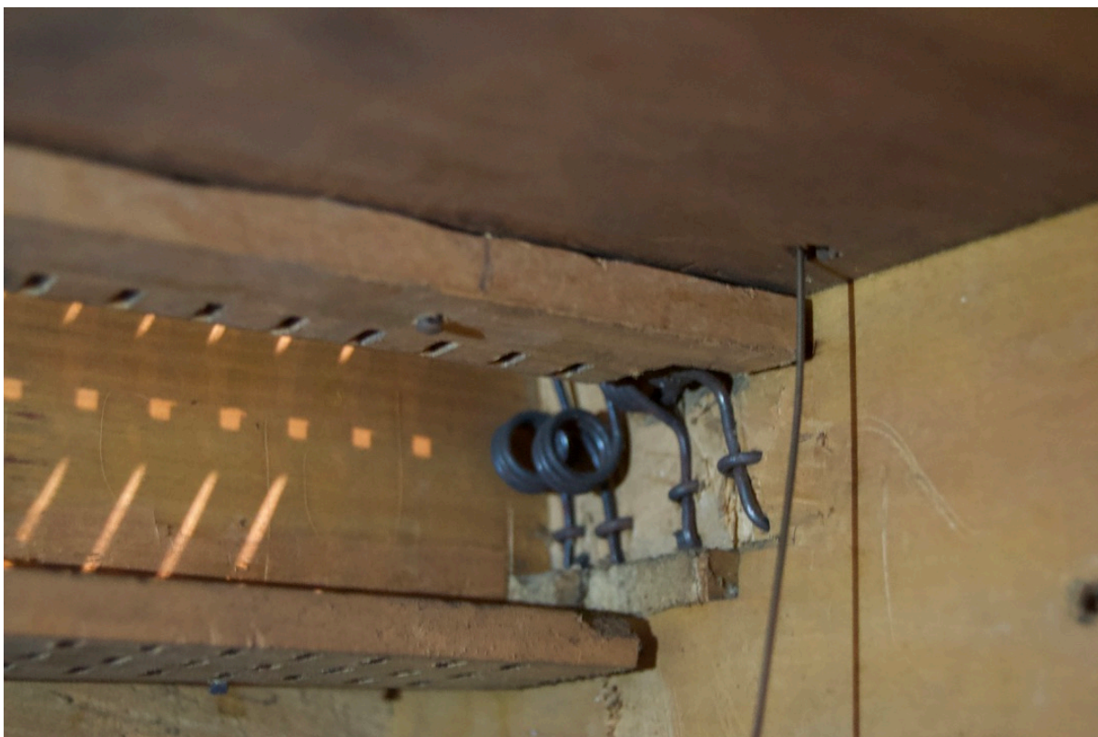
Figure 92: Vue de la joue par l'intérieur. Les ressorts sont fixés par dessous les registres.
