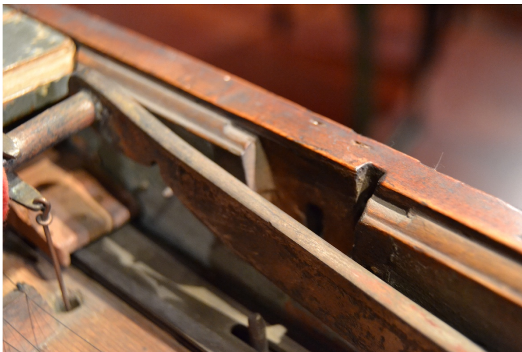
Figure 56: Détail du mécanisme du jeu de luth du côté de la joue de l'instrument. On voit également l'emplacement du mécanisme de la serrure permettant de fermer le couvercle qui est aujourd'hui manquant.
