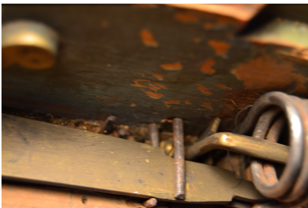
Figure 87: Les tirettes sont taillées en pointes et rentrent dans des agrafes plantées dans les registres.
