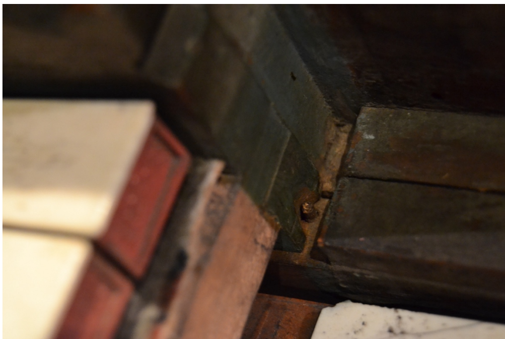
Figure 101: Des pointes permettent d'aligner le clavier supérieur sur le clavier inférieur.
