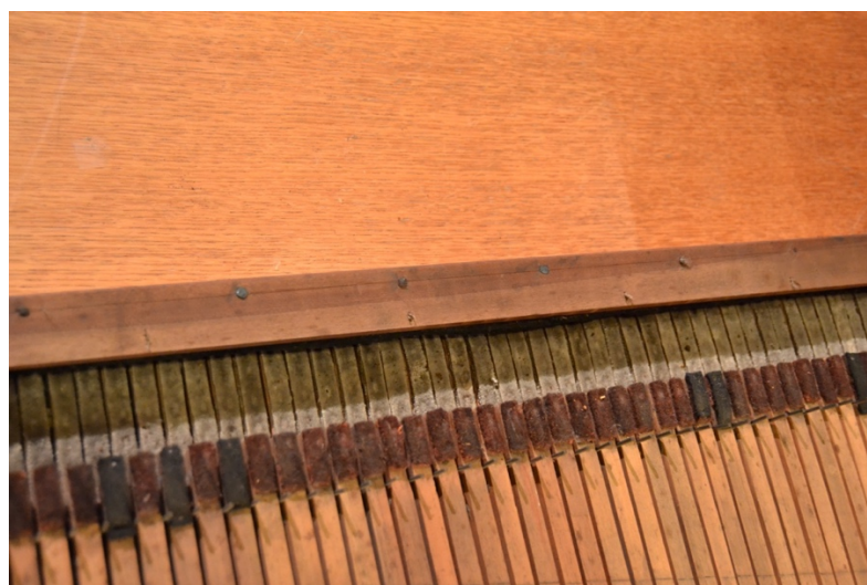
Figure 120: Vue des feutres des deux claviers. On peut voir l'uniformité des feutres du clavier inférieur comparé au clavier supérieur. On y voit aussi la barre d'arrêt du peigne du clavier inférieur. Cette barre permet d'arrêter la course des touches. Elle est clouée par-dessus le peigne.
