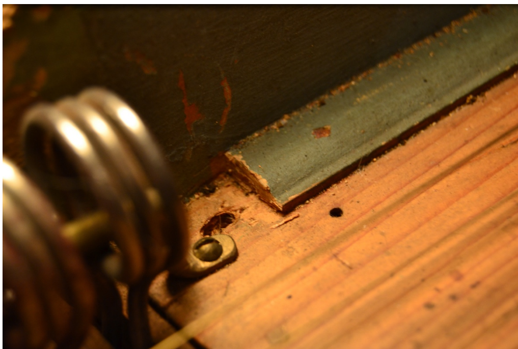
Figure 90: Détail de la barre en laiton passant à travers les ressorts. Cette barre a été refixée plusieurs fois et un nouveau trou pour la vise a dû être percé à côté de l'ancien.
