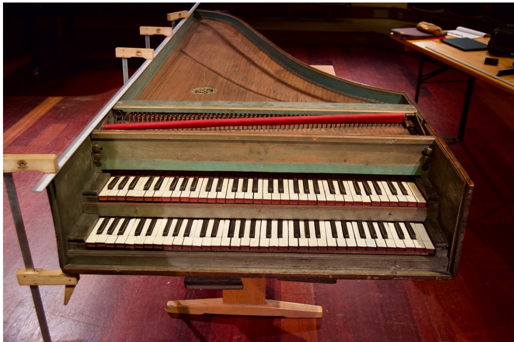
Figure 30: Photo de face de l'instrument. Le couteau et le couvercle sont déjà enlevés de l'instrument. Le système fixé sur l'échine permet de mesurer les coordonnées X et Y afin de recréer le plan de l'instrument.
