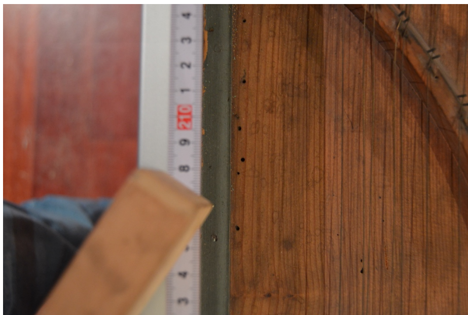
Figure 74: Dégâts d'insectes xylophages dans la table d'harmonie. Ils sont similaires aux trous également présents dans l'échine.
