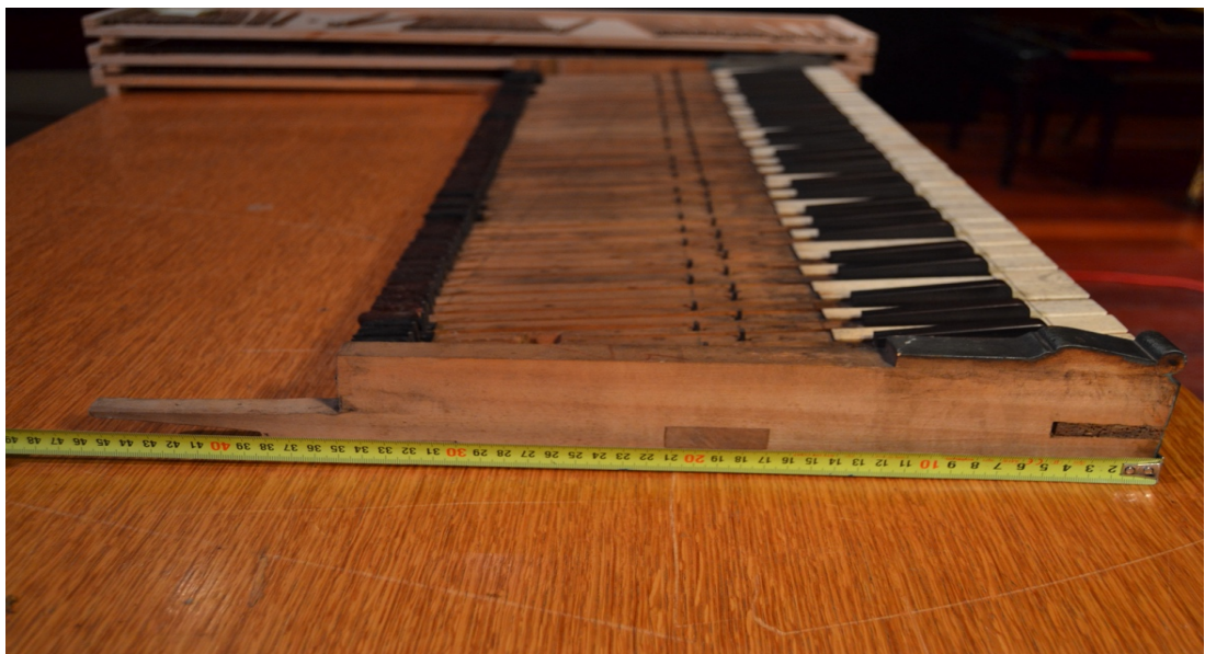
Figure 98: Vue latérale du clavier supérieur. On y voit les mortaises traversantes qui jointent l'ensemble du châssis.
