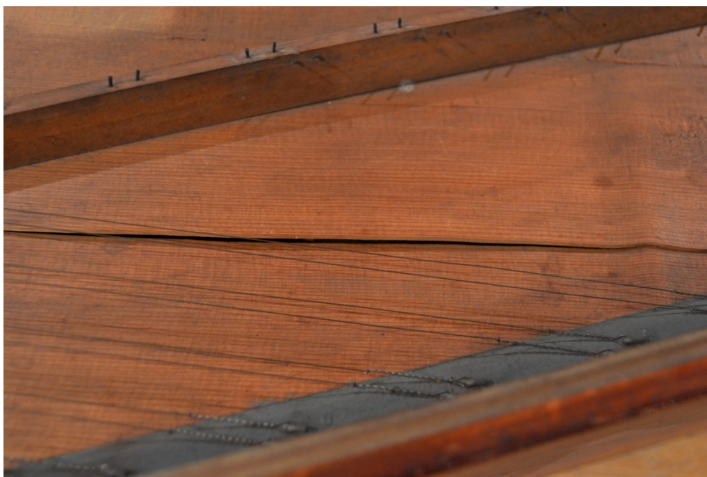
Figure 72: Détail de la fente qui s'étend entre le chevalet et l'éclisse courbe dans le sens des fibres de la table d'harmonie.
