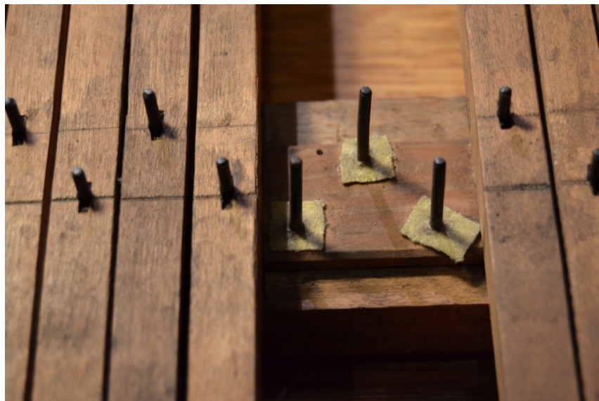
Figure 110: Bloc de balancier du clavier inférieur. Le bloc est composé de deux parties différentes : une fine languette est fixée sur le bloc et permet le balancement des touches.
