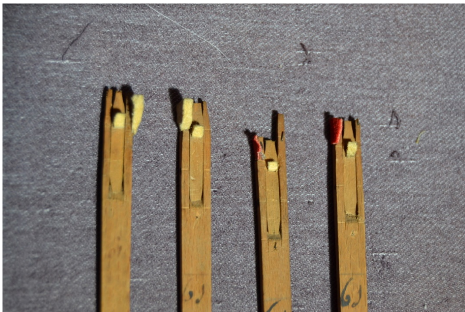
Figure 125: Détail de la languette des sautereaux.
