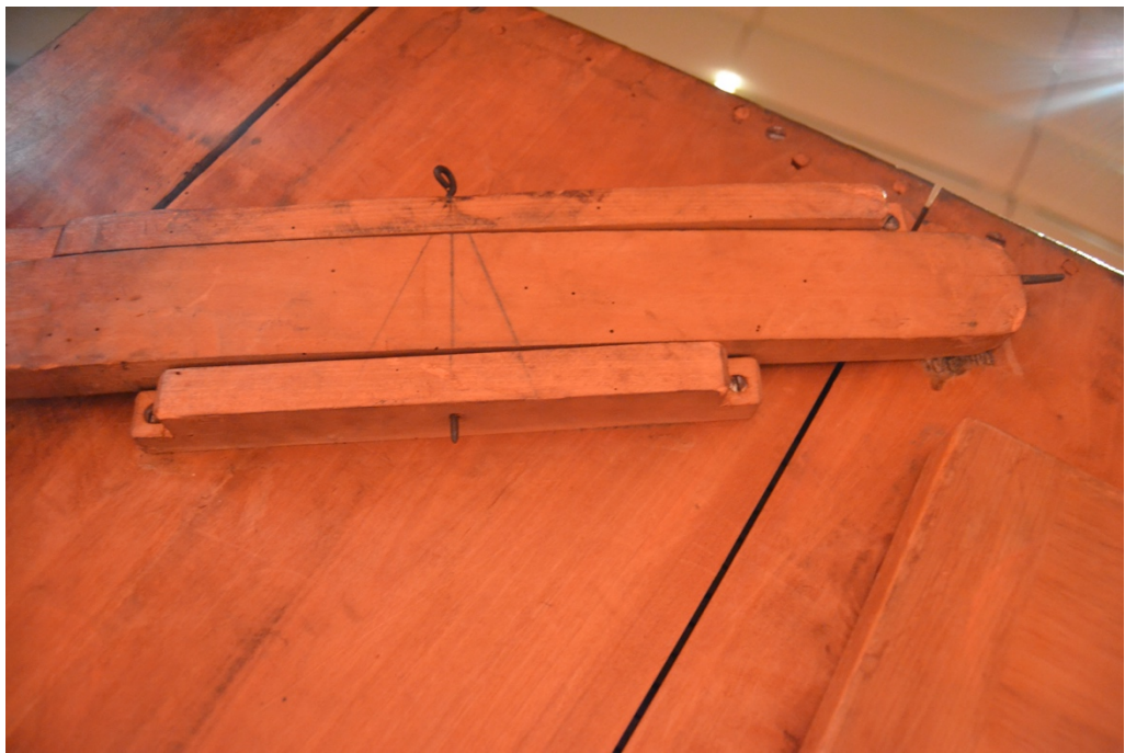
Figure 40: Genouillère. On y voit le pivot et les vises qui tiennent le bloc de genouillère.
