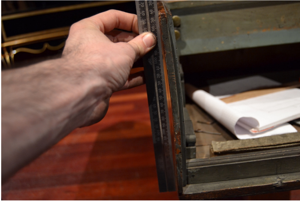
Figure 62: Déformation de l'échine. Cette déformation rend l'insertion des claviers plus difficile.
