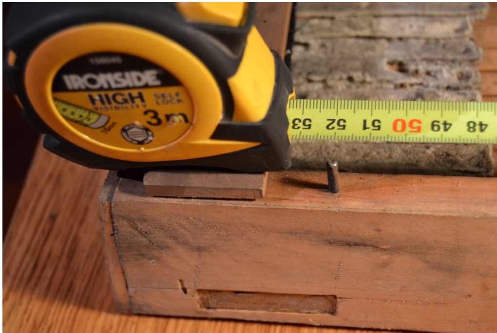
Figure 103: Deux autres pointes qui se trouvent à l'arrière des bras du clavier inférieur.
