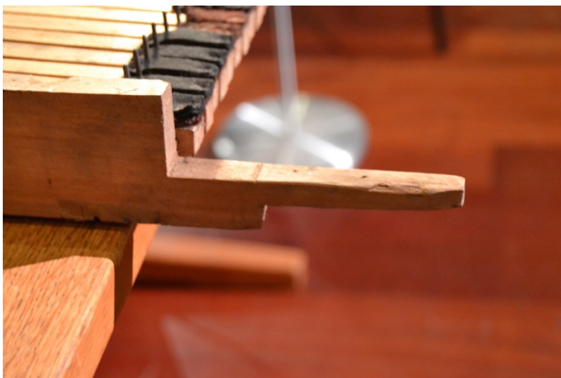
Figure 111: La forme de l'extrémité des bras à l'intérieur de la caisse correspond à trois besoins essentiels. Premièrement, la chute perpendiculaire au-dessus du bras permet de passer en dessous des trois premiers jeux de sautereaux du clavier inférieurs fixés sur le contre sommier. Deuxièmement, la longue pointe permet de se référencer contre la masse de l'instrument afin de bloquer l'avancée du clavier dans la caisse. Troisièmement, la découpe verticale sur le bas du bras permet de passer au-dessus de la barre d'arrêt des sautereaux fixée sur le peigne.
