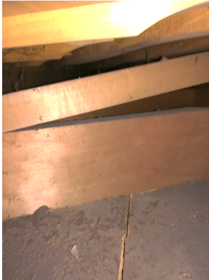
Figure 94: Intérieur de l'instrument depuis l'écart entre le contre sommier et la masse. On voit ici la première traverse de fond ainsi que les arcs boutants et dans la partie supérieure, les petites barres de table, le boudin et la grande barre. On voit également sur le renfort du fond, un numéro 7 au crayon rouge.
