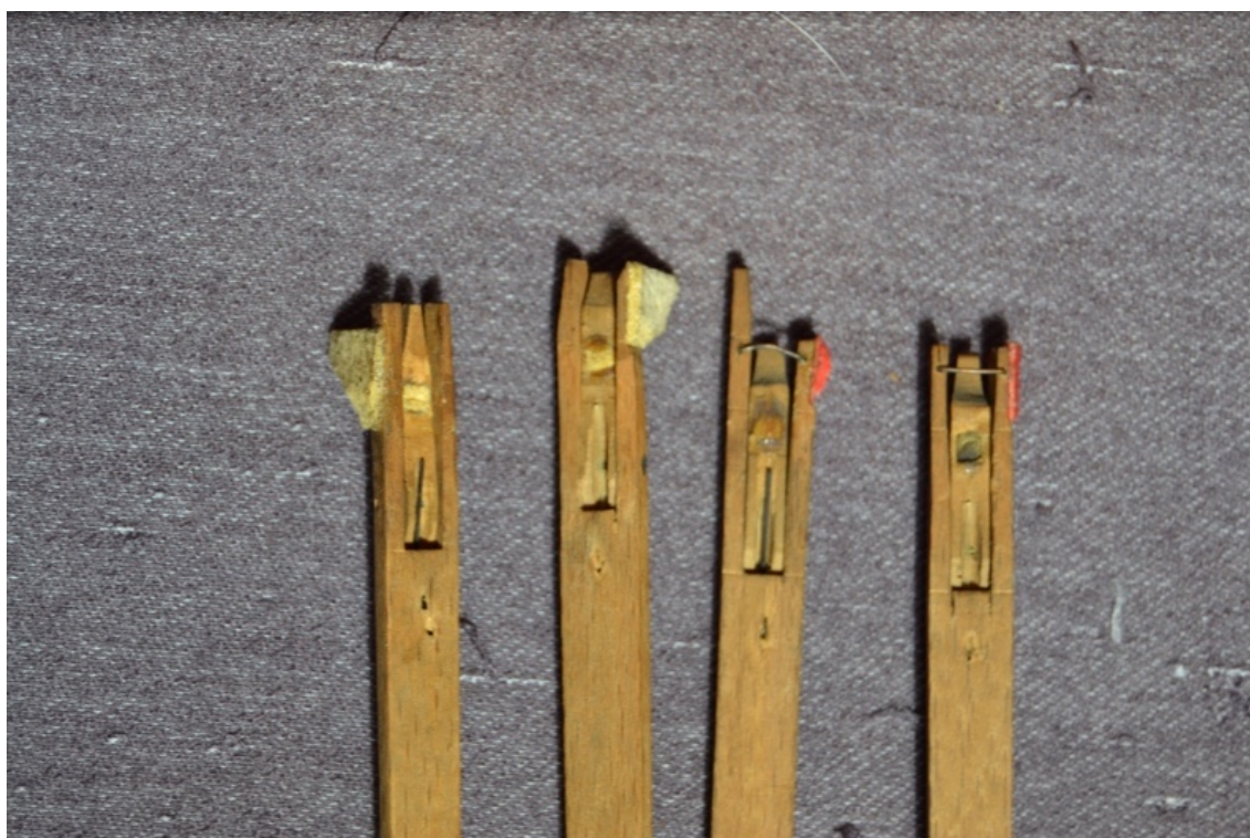
Figure 127: Vue arrière des sautereaux. On voit que les deux dernières rangées de sautereaux sont équipées d'agrafes empêchant la languette de revenir en arrière pendant la phase de réarmement du bec.
