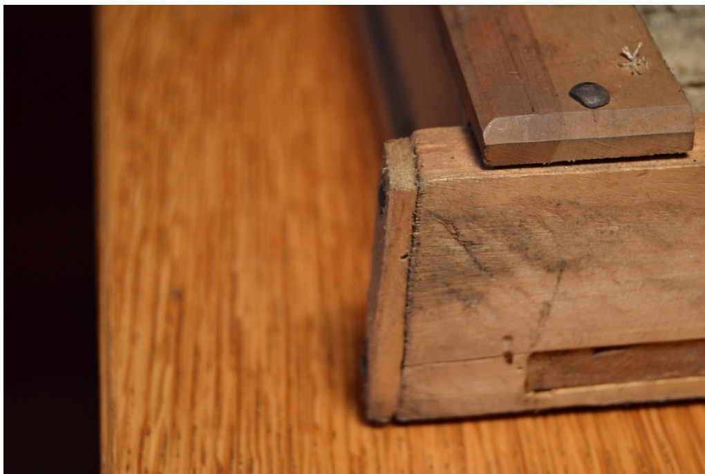
Figure 104: Rajout bras gauche du clavier inférieur qui a été rallongé par une petite pièce de bois collée et clouée sur l'extrémité arrière. Ce rajout sert à réaligner le côté gauche du châssis et à l'aligner dans la caisse de l'instrument.
