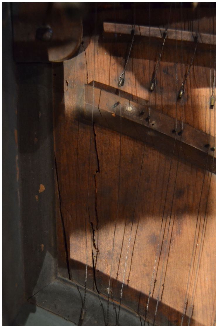
Figure 73: Cassures dans la partie aigue de la table d'harmonie. Les cassures sont dues à un assèchement du bois qui a cédé sous ses propres contraintes.
