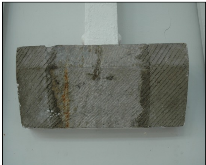
Fig.92: Corbeau présentant une taille diagonale (il a probablement été agrandi avec du béton, pour conserver l'unité d'ensemble, lorsqu'il a fallu en allonger d'autres à cause du déplacement naturel des charpentes), photographie personnelle, 06/10/2021.
