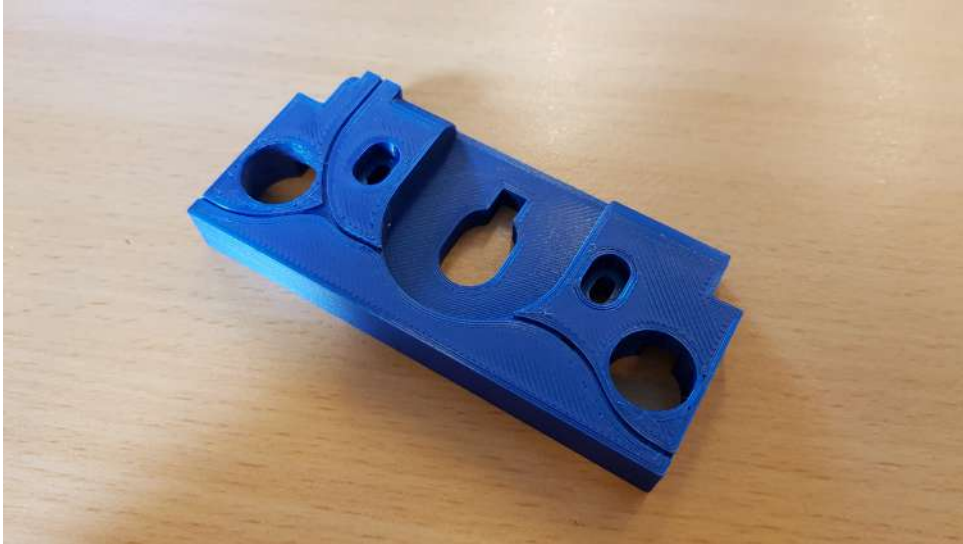
FIGURE 3.16 – Premier prototype d'une tête d'extrusion adapté au tubes fins
