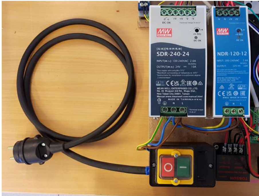
FIGURE 7.15 – Bloc d'alimentations 12 et 24 VDC
