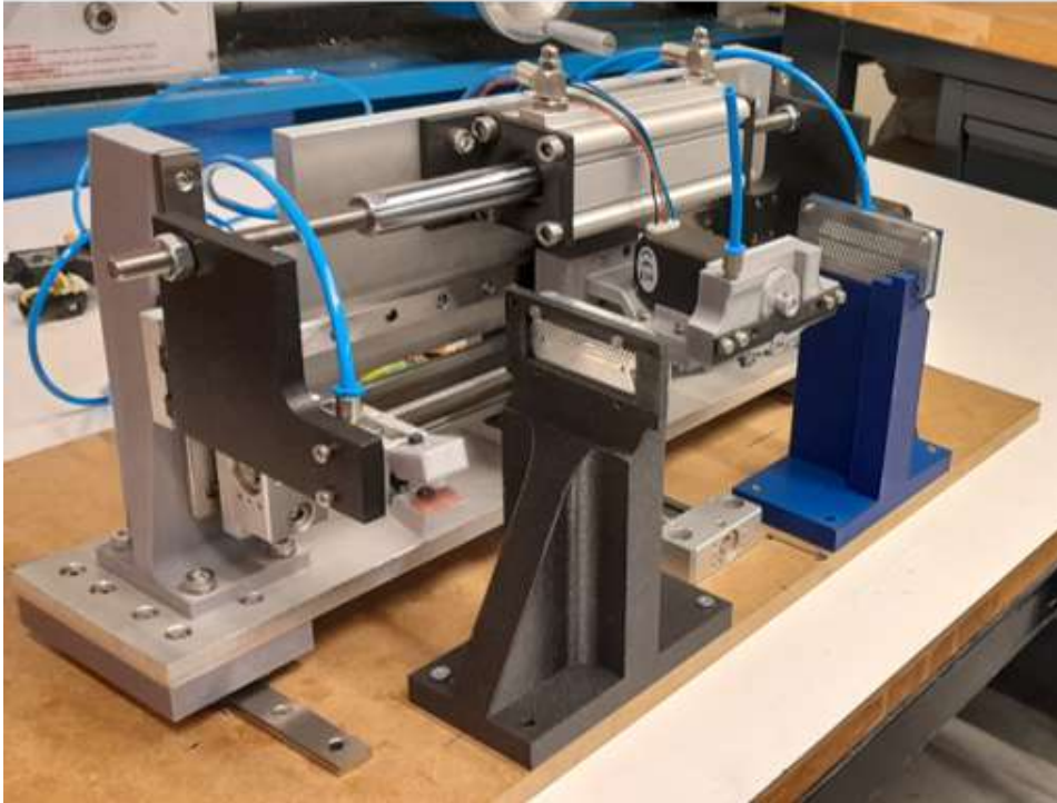
FIGURE 1.9 – Première conception de la machine à tuber
