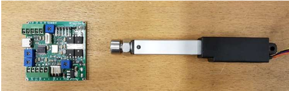
FIGURE 4.3 – Vérin électrique avec sa carte de contrôle
