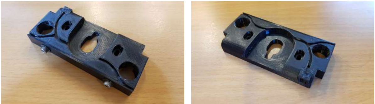
FIGURE 3.13 – Tête d'extrusion avec glissière intégrée
