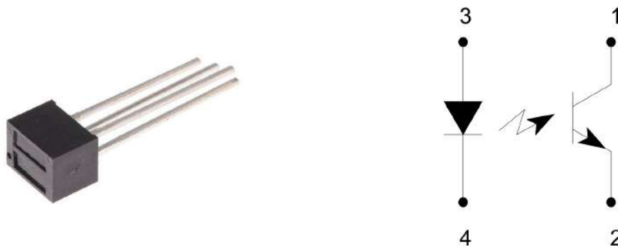
FIGURE 7.2 – Boîtier du capteur avec un schéma des composants présents
