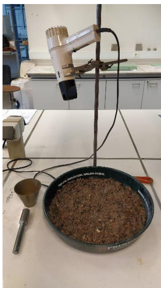
Figures 28: Séchage des granulats et vérification de la qualité du séchage
