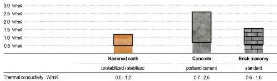
Figure 9 : Comparaison des conductivités thermiques entre la terre damée stabilisée ou non, le béton et la maçonnerie (source : Birznieks Lauris, 2013)
