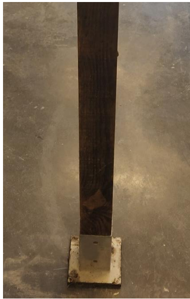
Figures 30: Dame et éprouvettes utilisées lors du compactage des blocs
