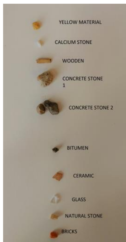
Figure 29: Typologie des éléments retrouvés par caractérisation visuelle
