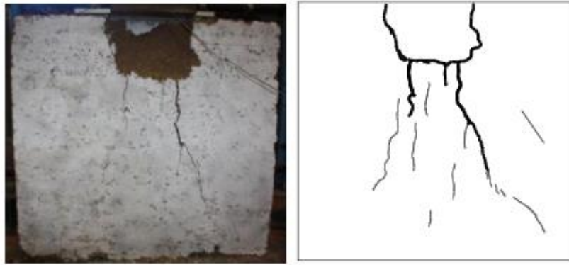
Figure 20 : Fissuration des murs tests sous compression (source : Bui, 2015)
