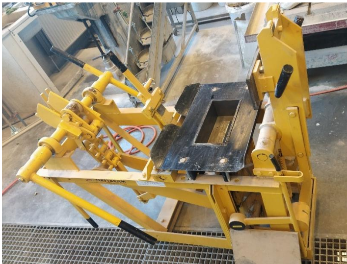
Figure 31: Presse et moule utilisés pour la confection des briques
