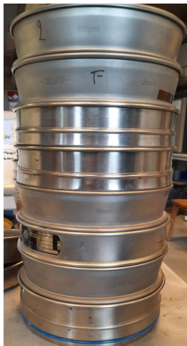
Figure 26 : Tamis utilisés lors de l'étude de granulométrie
