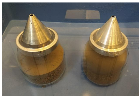
Figures 27: Pycnomètres utilisés lors de l'étude de l'absorption d'eau des granulats
