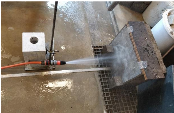
Figures 45: Réalisation du test d'érosion et résultat
