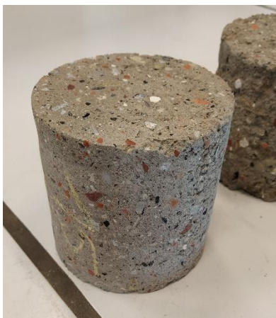
Figure 33: Eprouvettes cylindriques utilisées pour l'étude de l'absorption d'eau des mélanges
