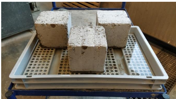
Figures 47 : Eprouvettes en phase de dégel et de gel
