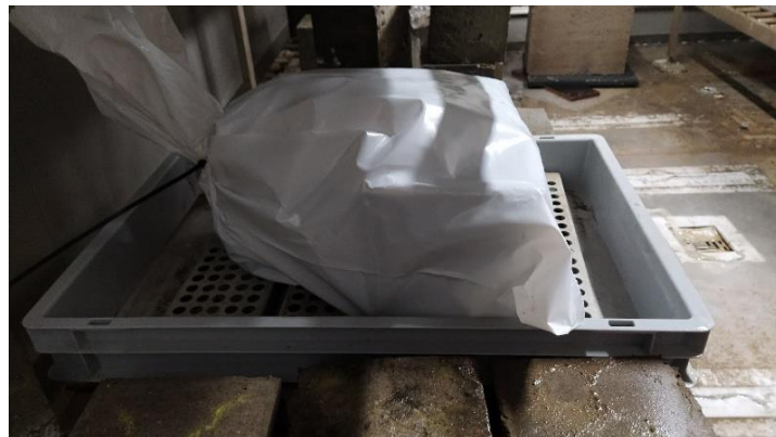
Figure 46 : Eprouvettes en chambre humide durant les périodes de non-test
