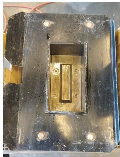
Figure 31: Presse et moule utilisés pour la confection des briques
