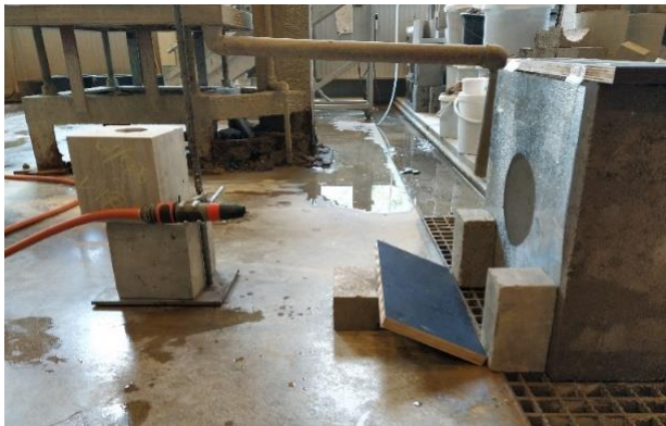
Figures 44: Mise en place avant le test d'érosion
