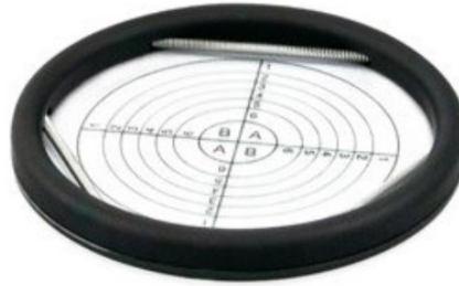
Figure 102 : Grille de comptage Spiral (Interscience, 2022)
