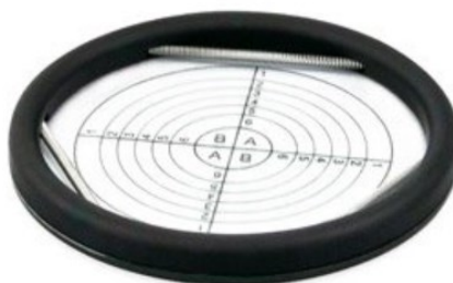
Figure 102 : Grille de comptage Spiral (Interscience, 2022)
