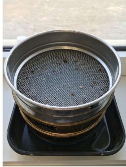
(b) Passage du mélange en suspension au travers d'une colonne de tamis (ordre décroissant : 2 mm, 1 mm, 0.5 mm)
