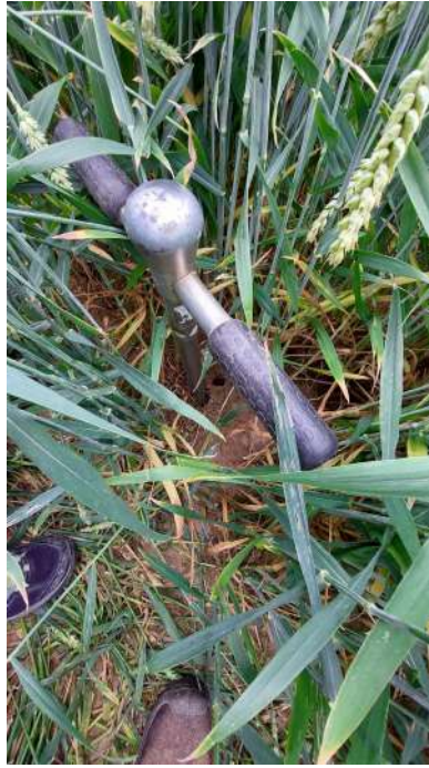
FIGURE 3 – Echantillonnage racinaire à la tarière gouge sur l'inter-rang et sur la ligne de semis
