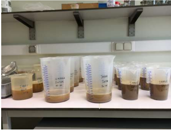
(a) Décantation des échantillons de sol dans une solution saturée en sel
