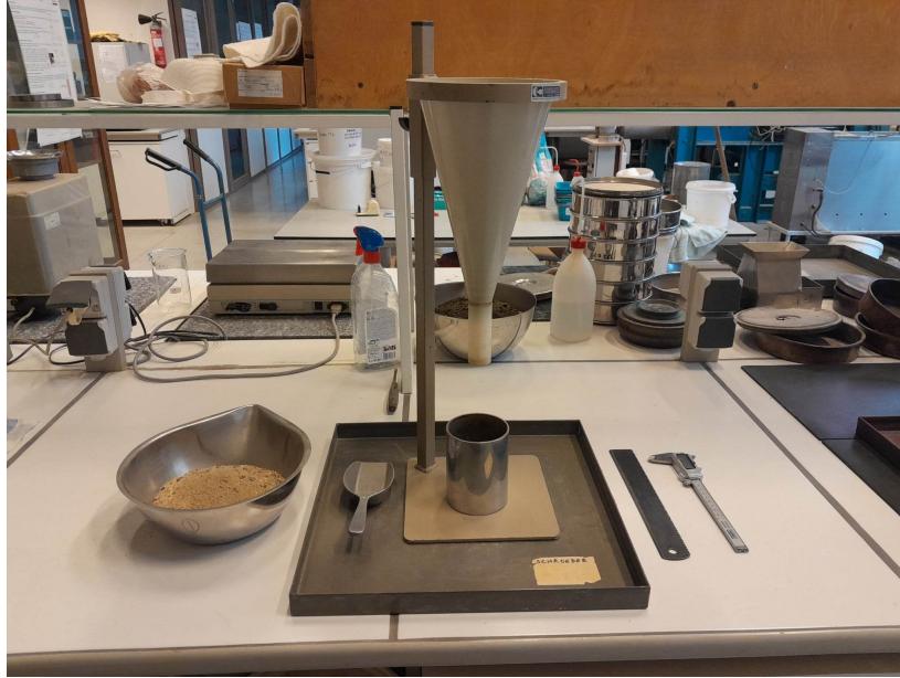
FIGURE 4.2 – Dispositif de l'essai de la masse volumique apparente
