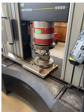
FIGURE 6.12 – Presse pour l'essai de flexion
