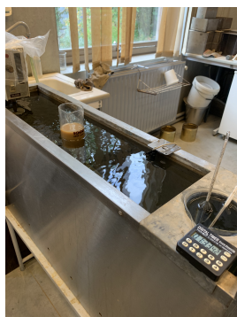
FIGURE 4.3 – Matériel pour réaliser une sédimentométrie
