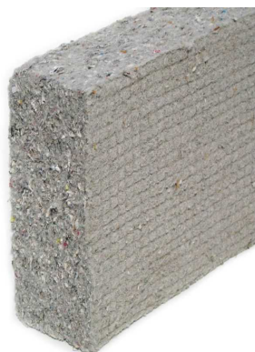
Figure 5-6 : Représentation de la ouate de cellulose
