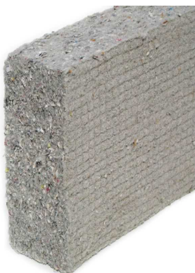
Figure 5-12 : Représentation de la ouate de cellulose
