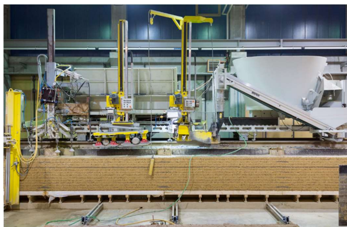
Figure 16 : Machine pour la fabrication des éléments en pisé © Emmanuel Dorsaz / Lehm Ton Erde
