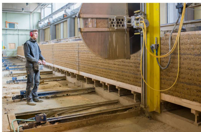
Figure 18 : Découpe du mur préfabriqué à la longueur de l'élément © Emmanuel Dorsaz / Lehm Ton Erde
