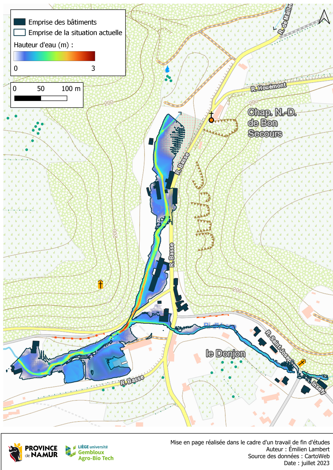
FIGURE 58 – Répartition des hauteurs d'eau pour le scénario 3 - reconstruction partielle du mur et émissaire de crue.
