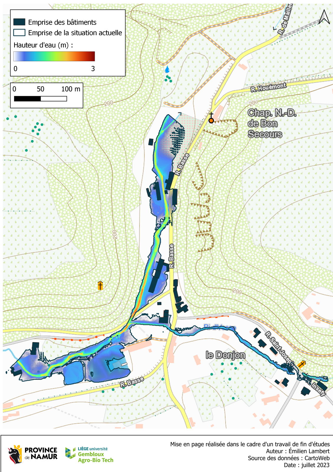
FIGURE 61 – Répartition des hauteurs d'eau pour le scénario 5 - modification de la confluence.
