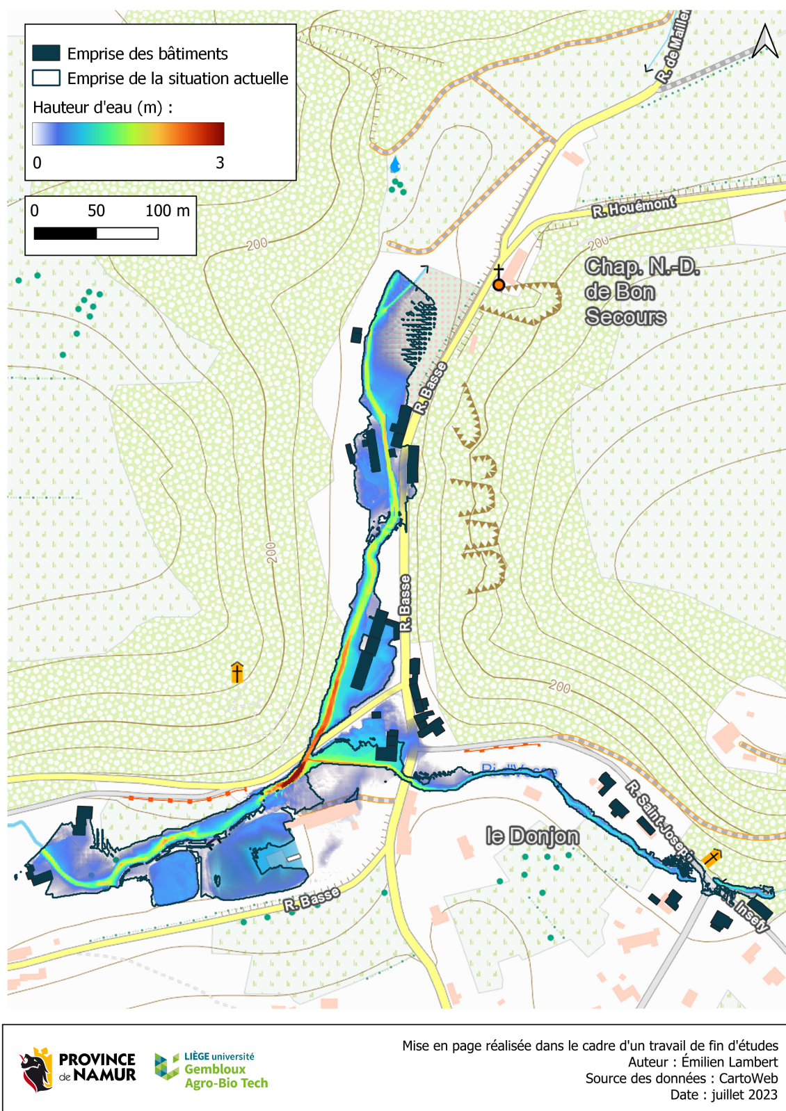
FIGURE 60 – Répartition des hauteurs d'eau pour le scénario 4 bis - combinaison des scénarios 3 & 4.
