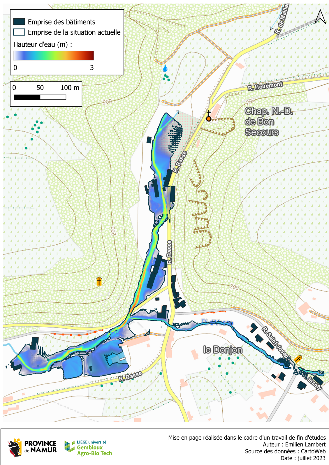
FIGURE 64 – Répartition des hauteurs d'eau pour le scénario 8 - création d'une banquette.
