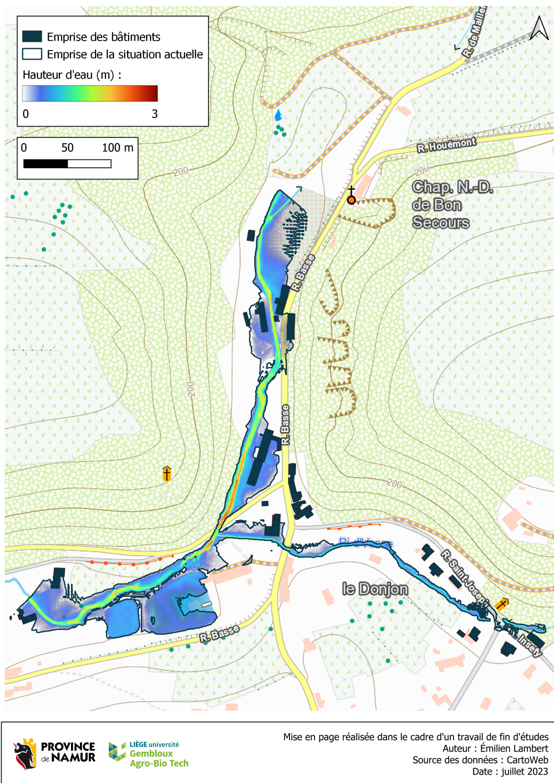
FIGURE 63 – Répartition des hauteurs d'eau pour le scénario 7 - suppression de la chute.
