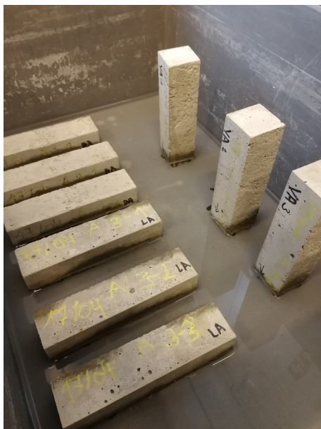
FIGURE 4.22 – Essai d'absorption par capillarité sur les différentes faces des échantillons
