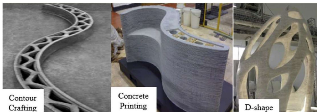
FIGURE 2.1 – Les trois méthodes principales d'impression 3D béton [ŞAHIN et MARDANI-AGHABAGLOU 2022]
