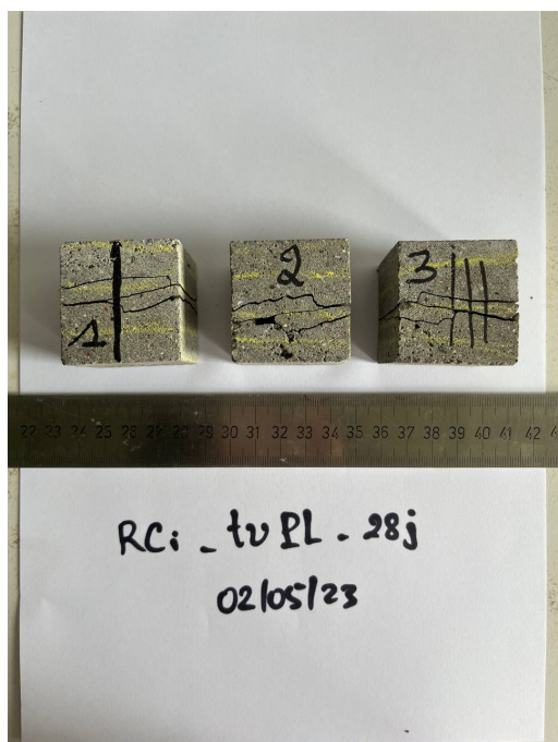
FIGURE 4.7 – Rupture en cisaillement - Échantillons imprimés à Limelette, après 28 jours
