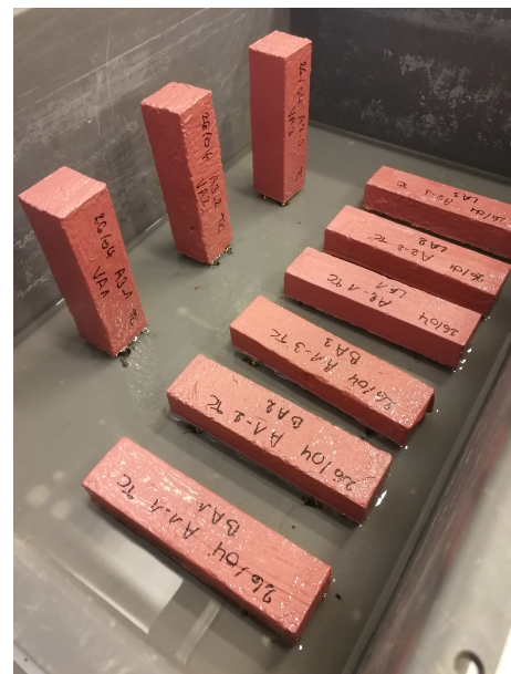
FIGURE 4.23 – Essai d'absorption par capillarité avec de la peinture sur les surfaces non testées
