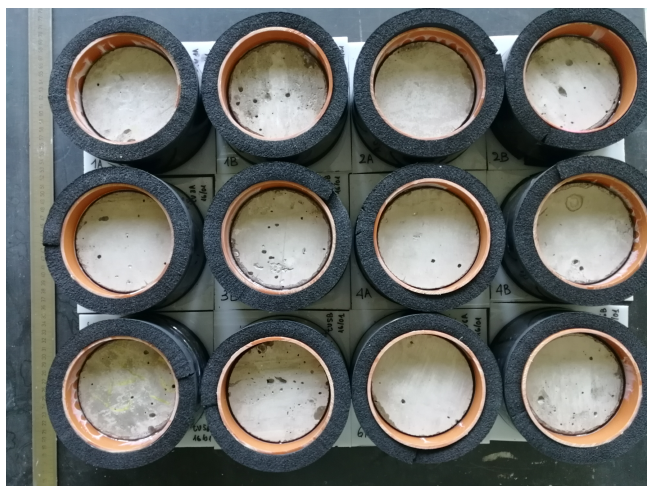
FIGURE 4.30 – État de surface final après 91 jours pour les échantillons moulés à base de sable recyclé
