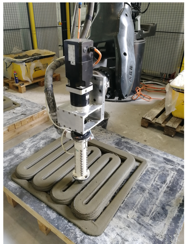
FIGURE 3.9 – Impression d'une "forme en S" à Limelette
