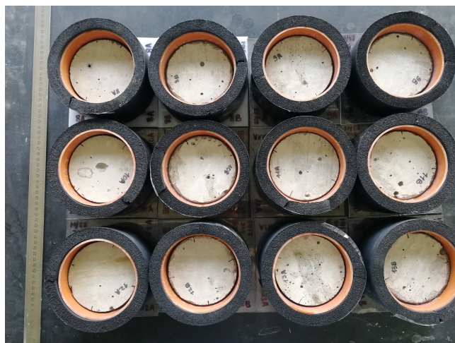
FIGURE 4.31 – État de surface final après 91 jours pour les échantillons moulés à base de sable naturel
