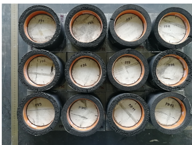
FIGURE 4.32 – État de surface final après 91 jours pour les échantillons imprimés à base de sable recyclé
