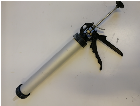
FIGURE 4.2 – Pistolet utilisé pour simuler l'impression
