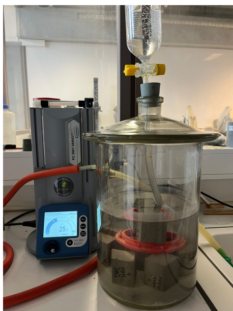
FIGURE 4.17 – Récipient connecté à l'appareillage à vide
