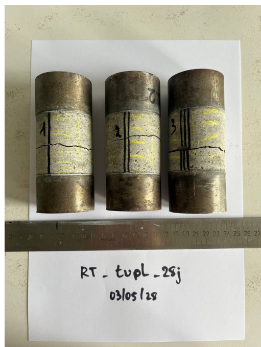
FIGURE 4.9 – Rupture en traction - Échantillons imprimés à Limelette, après 28 jours
