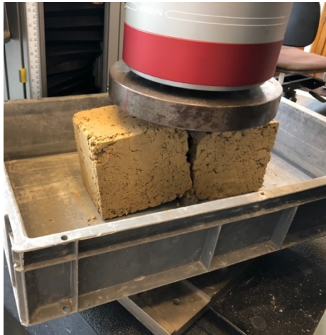
Figure 3.10 : Test de résistance en fendage
