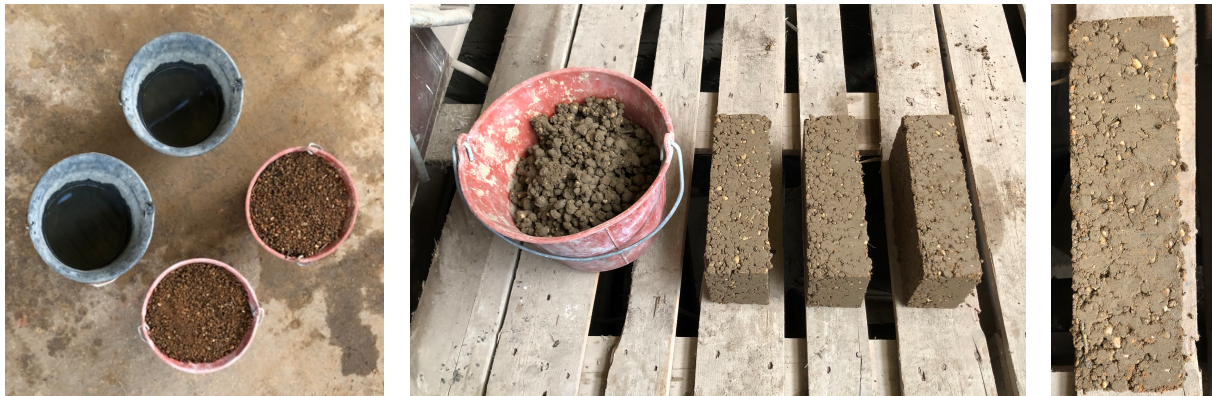
Figure 3.8 : Terre argileuse (+eau)
