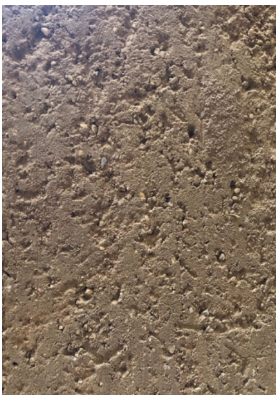
Figure 3.39 : Face coupée (façonnage)
