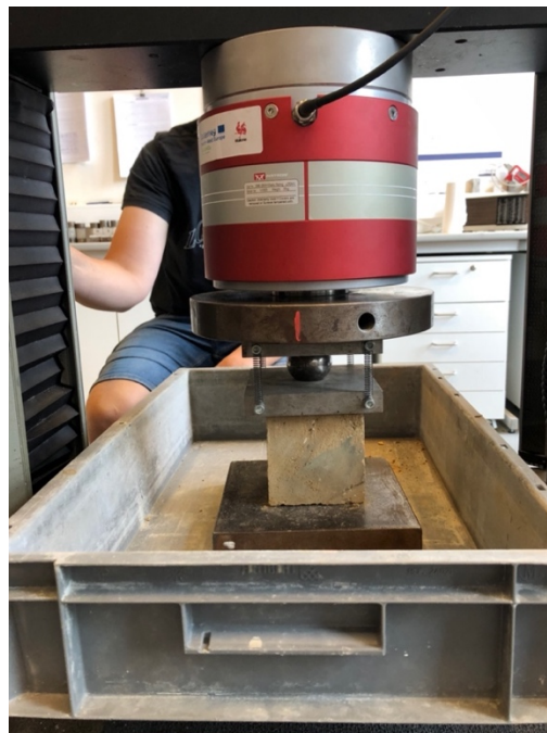
Figure 3.31 : Test de compression sur bloc 100 x 100 mm
