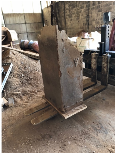
Figures 3.28 et 3.29 : Décoffrage des échantillons
