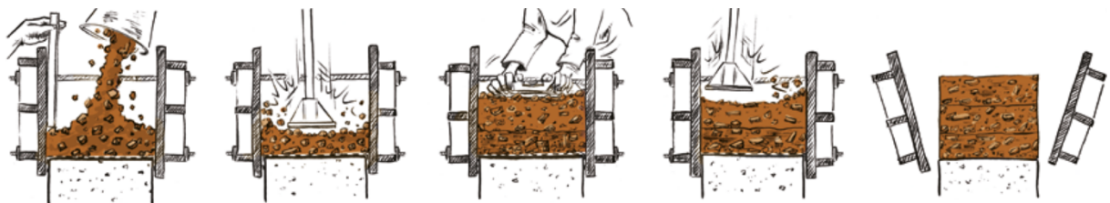
Figure 2.10 : Mise en œuvre du pisé traditionnel
