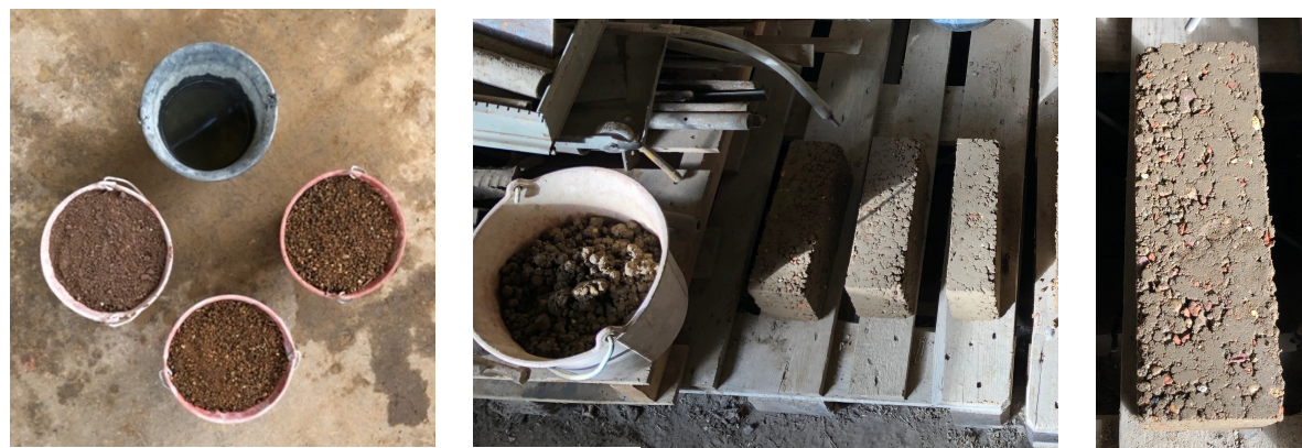
Figure 3.9 : Terre argileuse + granulats recyclés (-eau)
