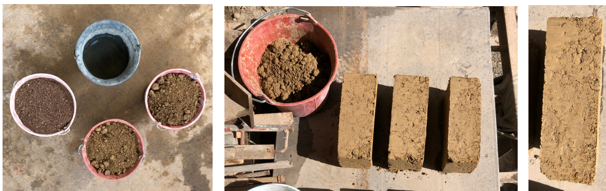
Figure 3.6 : Terre limoneuse + granulats recyclés (-eau)
