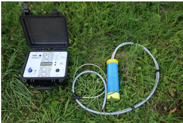
FIGURE 1.21 – PERMEA3 : perméamètre autonome (SIG France, 2023).
