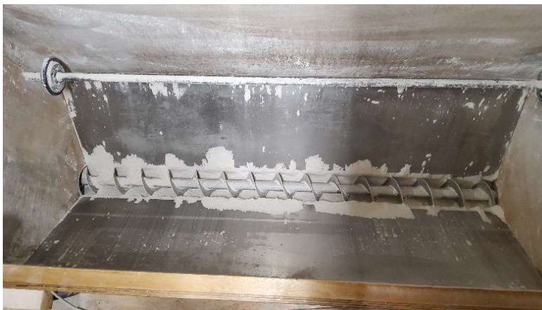
Figure 16: visse sans fin dans la bluterie après brossage des parois
