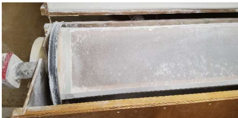
Figure 13: photo du tamis situé dans la bluterie
