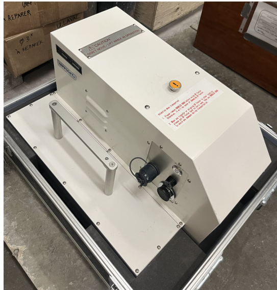
FIGURE 3.2 – Appareil DFT pour la mesure du coefficient de friction
