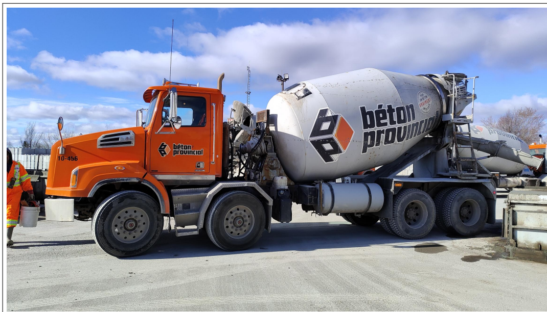
FIGURE 3.1 – Camion malaxeur de 8 m 3 de Béton Provincial (456)
