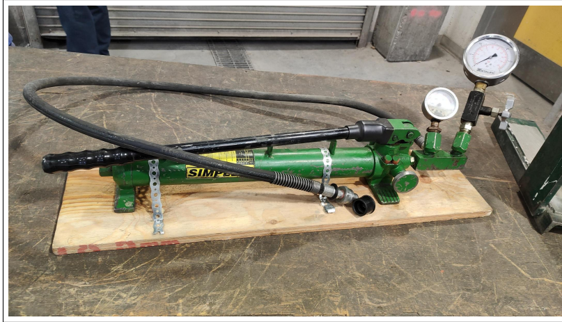
FIGURE 3.6 – Pompe hydraulique manuelle (capacité : 700 bars)
