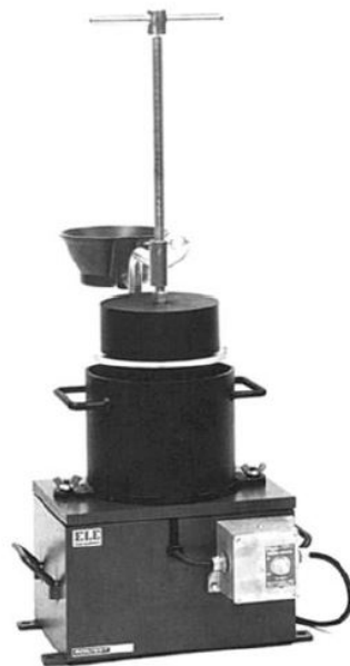
FIGURE 2.9 – Appareillage d'un consistomètre Vébé modifié (ACI, 2002)
