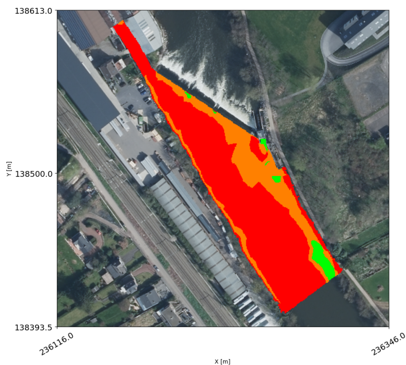
Figure 6.44: Méry / superposition des critères hydrauliques / Q=18,4 \text{ m}^3/s
