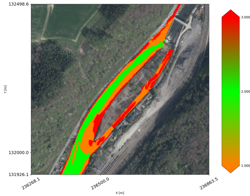
Figure 7.9: Chanxhe / superposition des critères hydrauliques / Q=16\text{m}^3/\text{s}
