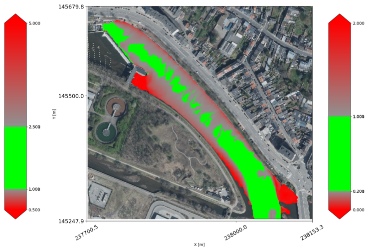
Figure 6.55: Grosses-Battes / h / validité / Figure 6.56: Grosses-Battes / \nabla \vec{u} / validité / Q=33\text{m}^3/\text{s}
