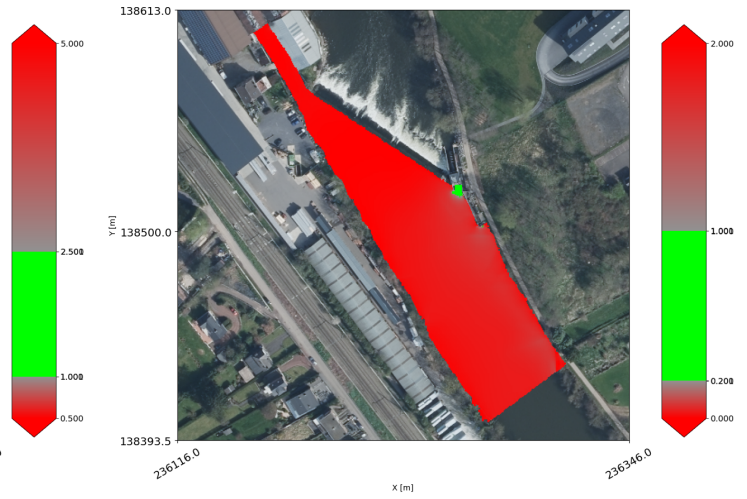
Figure 6.45: Méry / h / validité / Q=5,15 \text{ m}^3/\text{s} Figure 6.46: Méry / \vec{u} / validité / Q=5,15 \text{ m}^3/\text{s}
