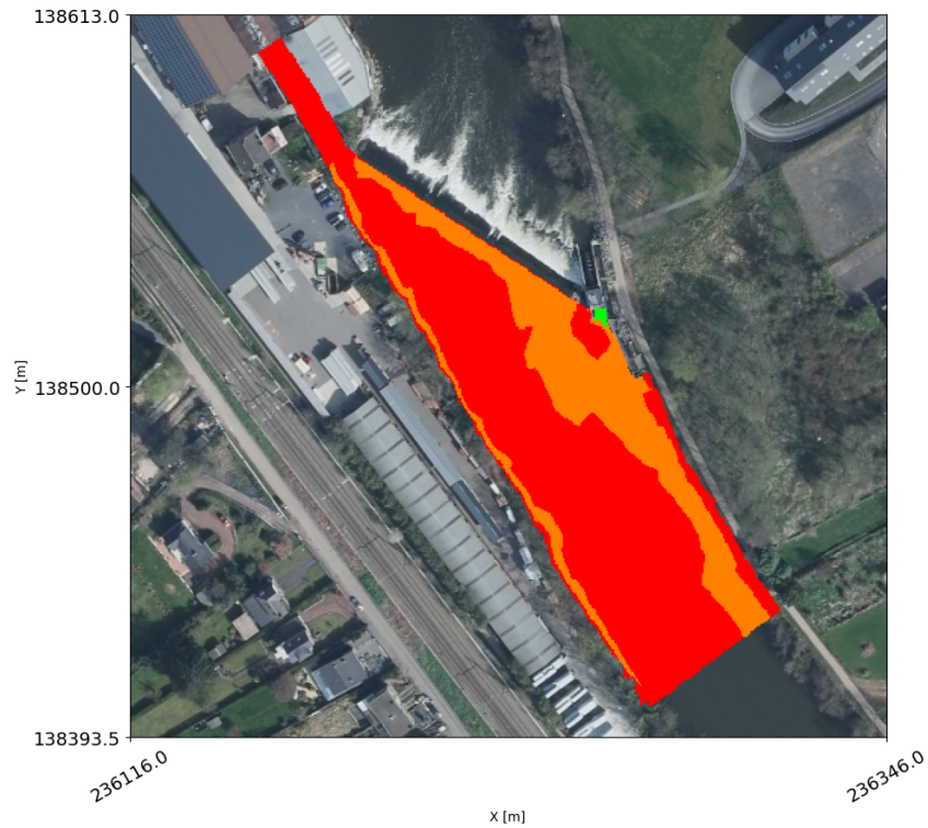
Figure 6.47: Méry / superposition des critères hydrauliques / Q=5,15 \text{ m}^3/\text{s}
