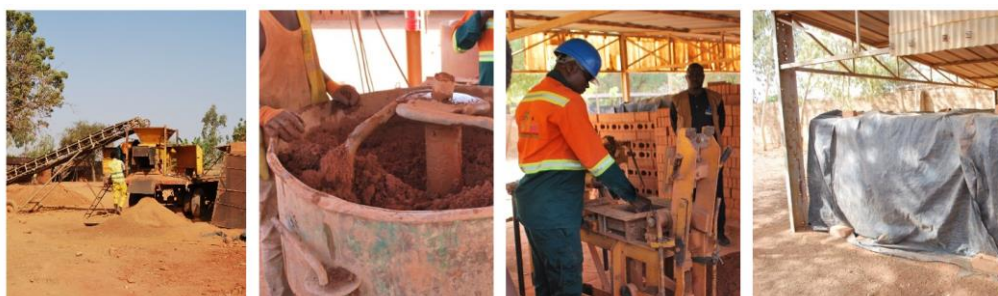
Figure 2-13 : Etape de production des BTC
