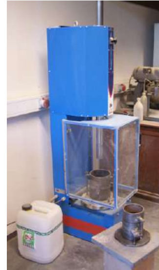
FIGURE 3.10 – Machine de compactage automatique Proctor [ARGENCO - LABORATOIRE DE GÉOTECHNOLOGIES, 2023e]
