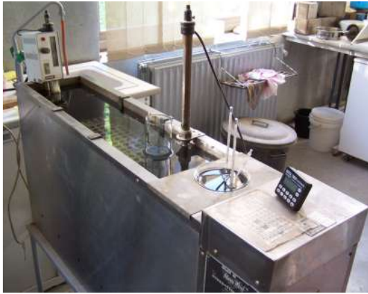
(a) Bain thermostatique [ARGENCO - LABORATOIRE DE GÉOTECHNOLOGIES, 2023b]
