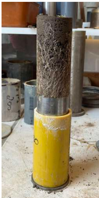
FIGURE 4.11 – Échantillon triaxial : étape 2
