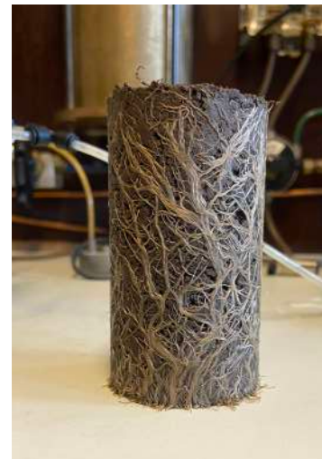
FIGURE 4.12 – Échantillon final pour essai triaxial
