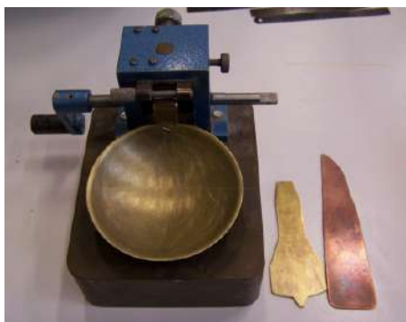
(a) Coupelle de Casagrande [ARGENCO - LABORATOIRE DE GÉOTECHNOLOGIES, 2023d]
