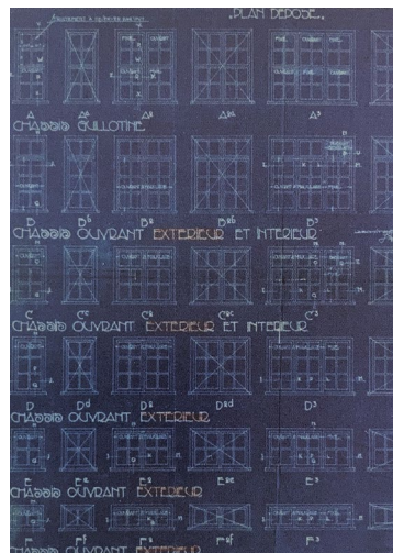
Figure 43: Châssis standardisés, vers 1922 - Archives du CIVA
