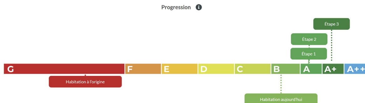
Figure 120: Résultat Quicksan avec l'installation de châssis double vitrage
