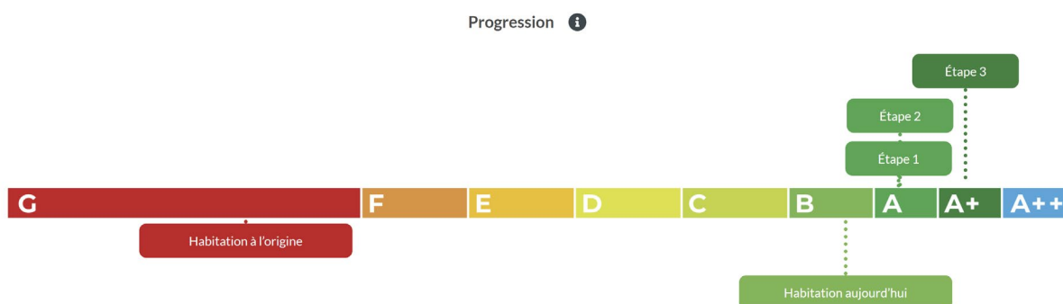
Figure 121: Résultat Quicksan avec prise en compte de l'isolant sous le plancher du rez-de-chaussée
