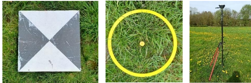
Figure 6 - Photos d'un GCP (gauche), d'une unité d'échantillonnage (milieu) et du Reach RTK (droite).
