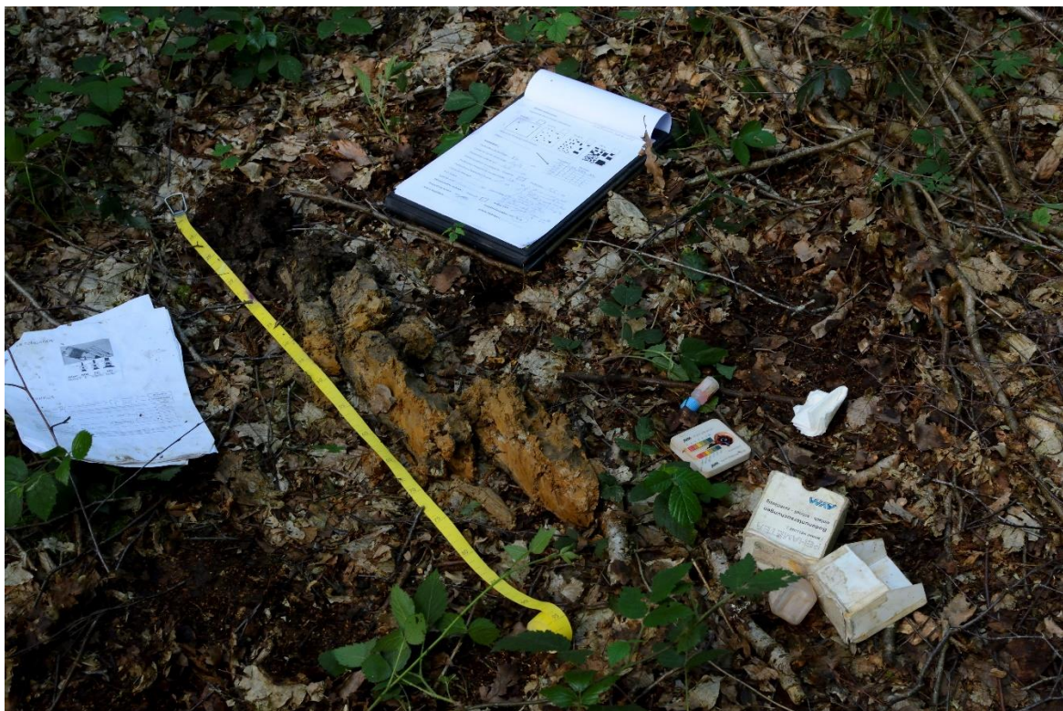
Figure 24. Analyse d'une carotte pédologique. A gauche ; la profondeur d'apparition des différentes informations clés du sol sont mesurées. A droite ; un test d'acidité à base de phénolphtaléine est réalisé.
