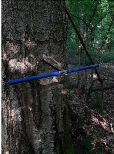
Figure 21. Prélèvement d'une carotte à l'aide d'une tarière de Pressler.
