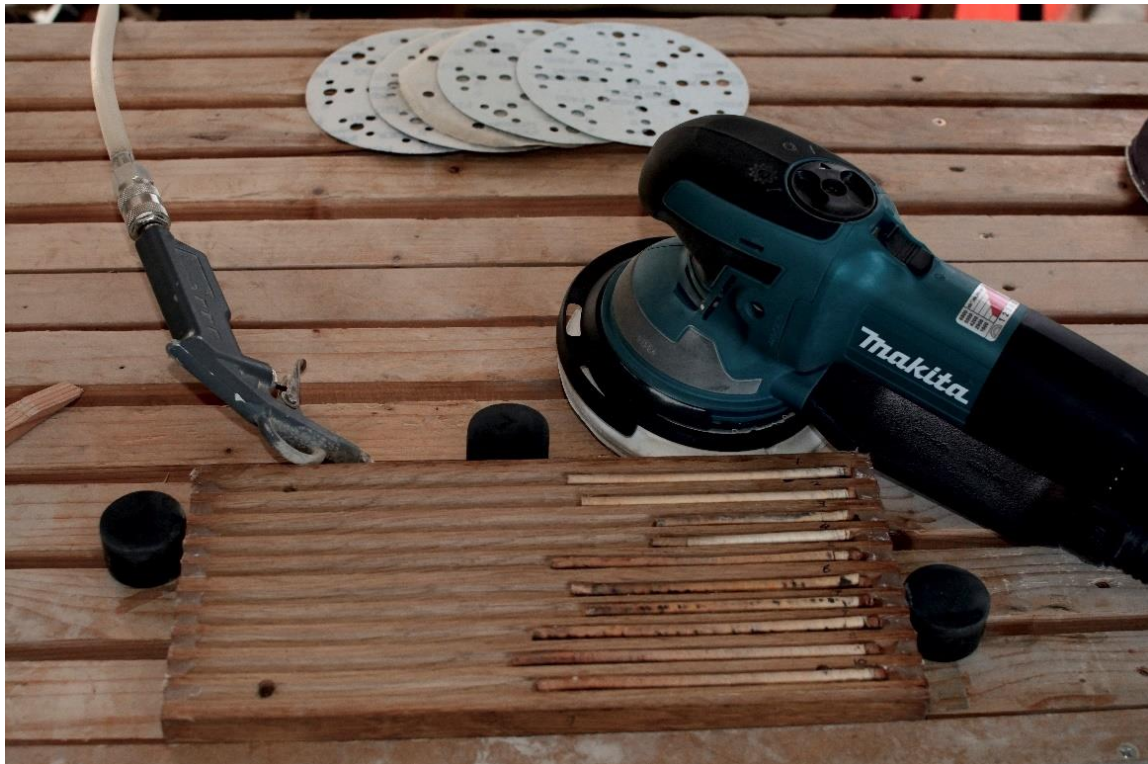
Figure 22. Atelier de ponçage de carottes. En haut ; les différents papiers ponces. A droite ; la ponceuse. En bas ; la plaquette contenant les carottes . A droite ; le pistolet du compresseur permettant de chasser la poussière du ponçage.
