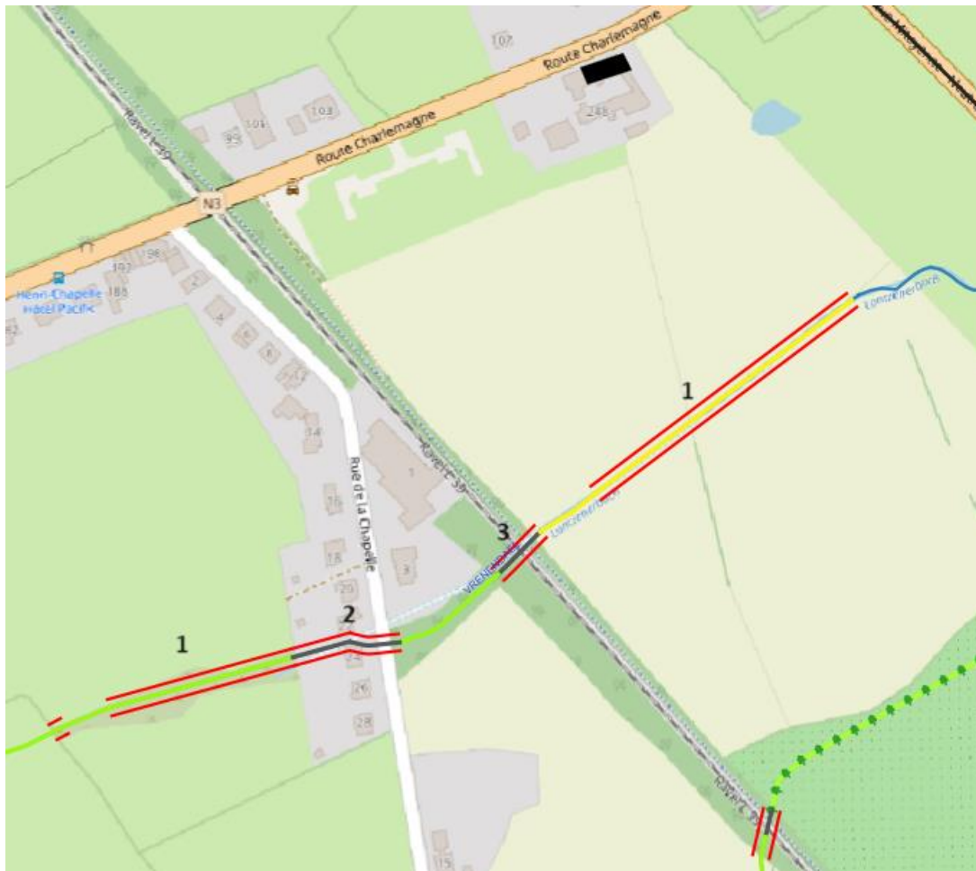
Figure 29 : Représentation des 3 types de canalisations
