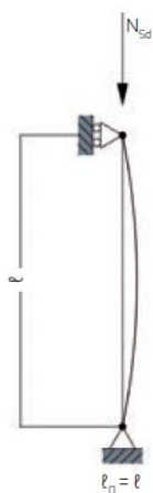
Figure 22 : Longueur de flambement (Ergon)
